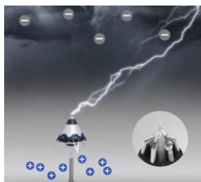
Figura 51 - Princípio de funcionamento de um PDI
