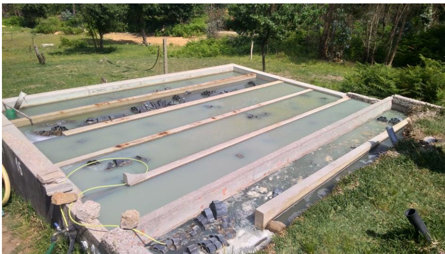
Figura 3.10 – Adição final de floculante e água oxigenada.
