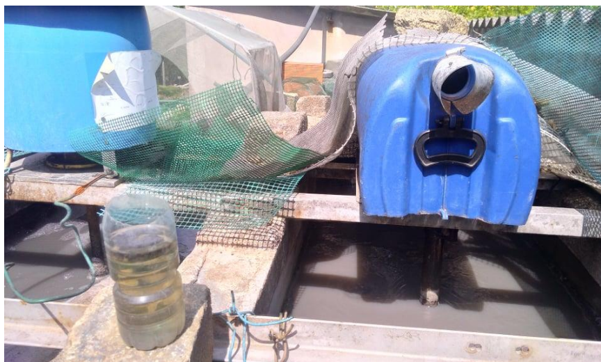
Figura 3.6 - Adições de floculante e coagulante.
