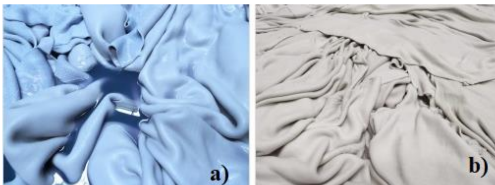
Figura 2.4 - Peles em estado wet-blue a) e wet-white b) [8].
