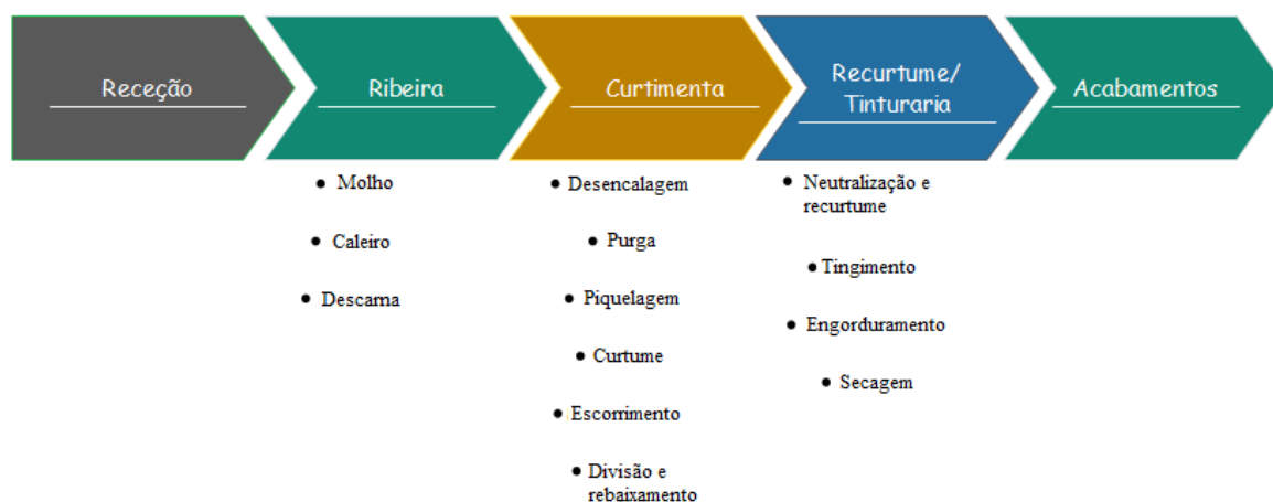
Figura 2.3 - Fases da produção de couro.
