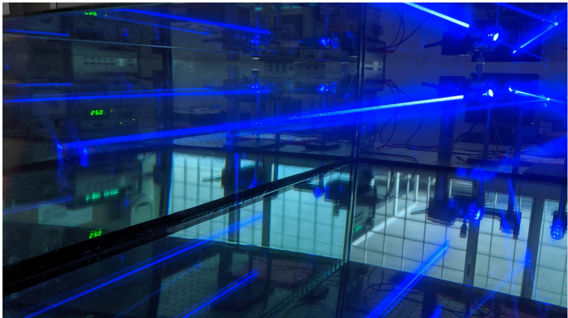
Figura 4.11: Tanque utilizado no ensaio experimental de avaliação da propagação em meio subaquático para uma distância de 3.25 m.
