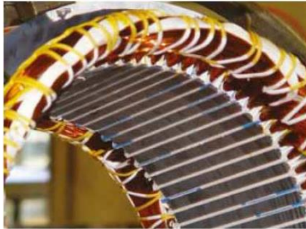
Figura 23 Isolamento do fio e da ranhura [8]
