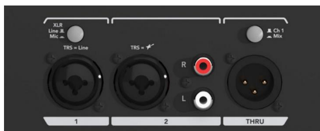
Figura 11 – Quadro de ligações de uma coluna amplificada
