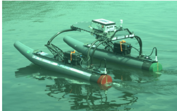
Figura 2.17: WAM-V USV16 durante os testes de station keeping [45]
