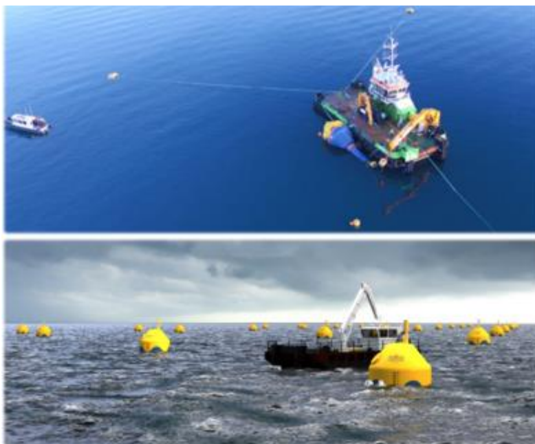
Figura 19 - Conceito de fazenda (ou parque) de ondas (adaptada de CorPower Ocean, 2019).
