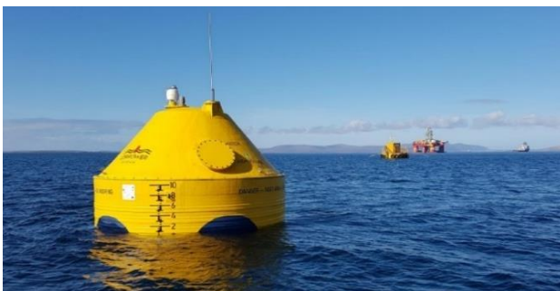
Figura 10 - Tecnologia CPOWEC tipo absorção pontual (CorPower Ocean, 2020).
