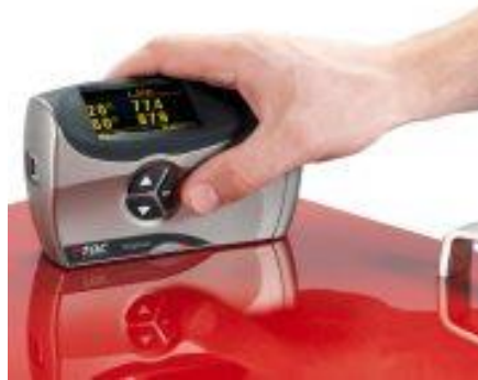
Figura 2.7 Determinação do brilho através de um medidor de brilho [30].
