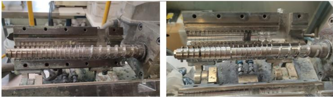
Figura 3.1 Fuso da extrusora dos tons escuros (à esquerda) e dos tons claros (à direita).
