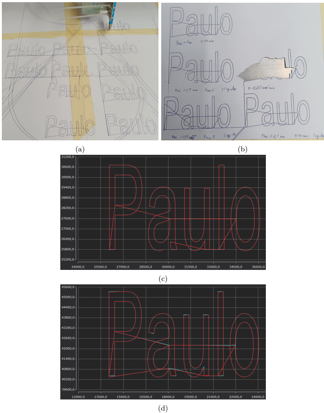
Figura 6.18: Teste efetuado ao código G "Paulo", onde o eixo horizontal corresponde ao eixo X e o eixo vertical ao eixo Y (Escala a 10^{-2}mm ): a) testes efetuados sem o G360 b) testes efetuados com o G360 c) teste com o G360 com a janela de 0,1 mm d) teste com o G360 com a janela de 1 mm
