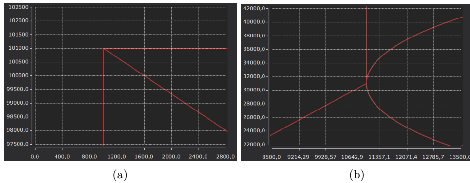
Figura 6.13: Correção dos erros encontrados do decorrer dos testes, onde o eixo horizontal corresponde ao eixo X e o eixo vertical ao eixo Y (Escala a 10^{-2}mm ): a) cantos b) troca repentina de direção
