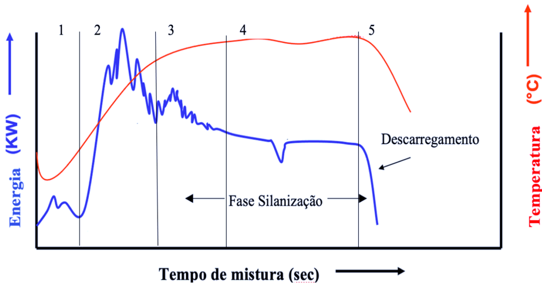
Figura 2.13: Representação gráfica da temperatura de mistura e da energia exercida pelo martelo em função do tempo de mistura (adaptado de (Feierabend, 2003)).
