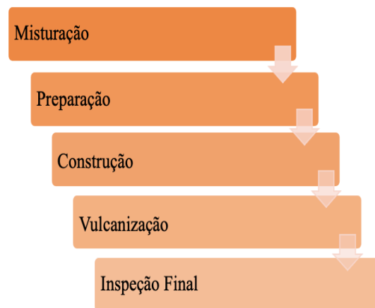
Figura 2.5: Representação das etapas do processo produtivo da fábrica.
