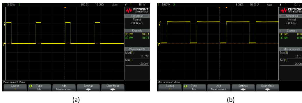
Figura 62: Formas de ondas de saída do IR2104 sendo em: (a) onda de HO (b) onda de LO, quando aplicado um PWM ao pino IN.
