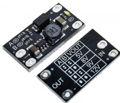
Figura 60: Conversor CC/CC utilizado para alimentação do driver IR2104.
