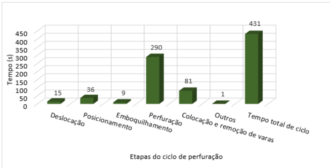
Figura 105. Caracterização do ciclo de perfuração médio na bacia de dissipação do AHFT (seg.).
