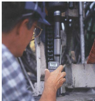
Figura 24. Medição da temperatura da união da vara (Atlas Copco, 2007/2008).
