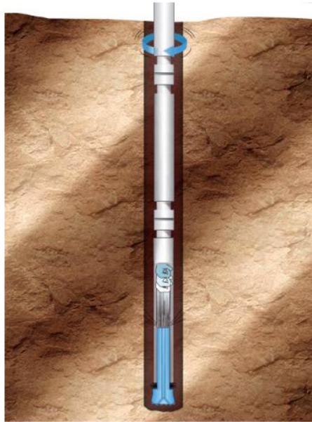
Figura 33. Martelo de fundo de furo ( Down the hole ) ( www.driconeq.com ).
