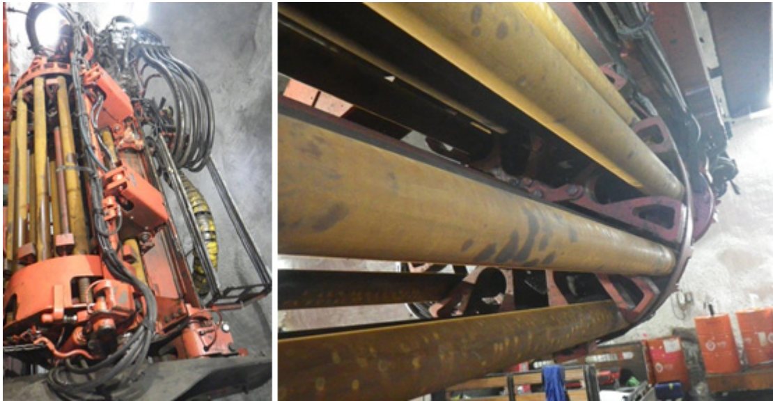
Figura 41. Equipamento de perfuração longa Sandvik DL421 – carrossel de varas de perfuração (cortesia: EPDM – Empresa de Perfuração e Desenvolvimento Mineiro).
