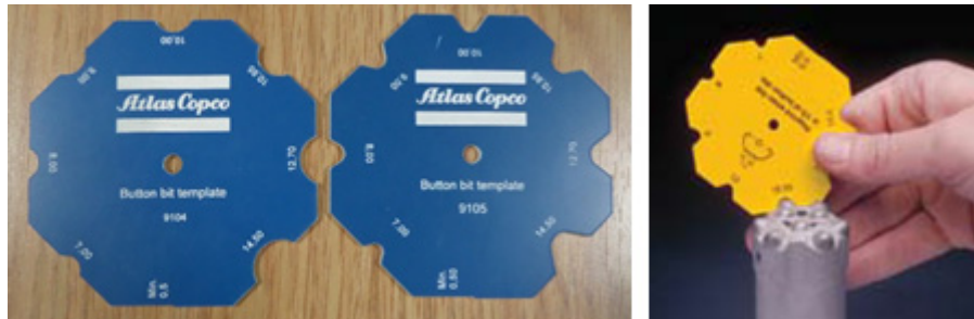
Figura 62. Esquerda - Escantilhão para botões esféricos e balísticos; Direita - Medição do desgaste dos botões com auxílio do escantilhão (Atlas Copco, 2007/2008).
