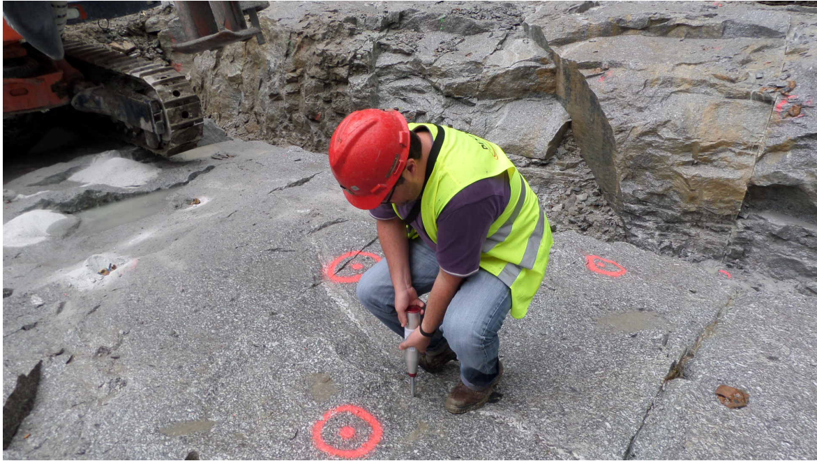
Figura 91. Ensaio com martelo de Schmidt (Bacia de dissipação do AHFT).
