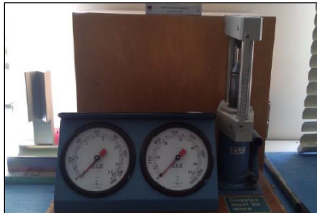
Figura 4. Equipamento utilizado para executar o ensaio de carga pontual, Point Load Test (cortesia: Laboratório de Mecânica das Rochas do Laboratório de Geotecnia e Materiais de Construção, ISEP).
