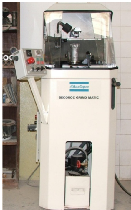
Figura 58. Equipamento de afiação de bits: Atlas Copco Grind Matic BQ2 (cortesia da Descavanor, SA – Grupo Elevo).
