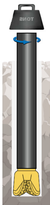
Figura 16. Método de perfuração rotativo com brocas tricônicas (Atlas Copco, 2012).
