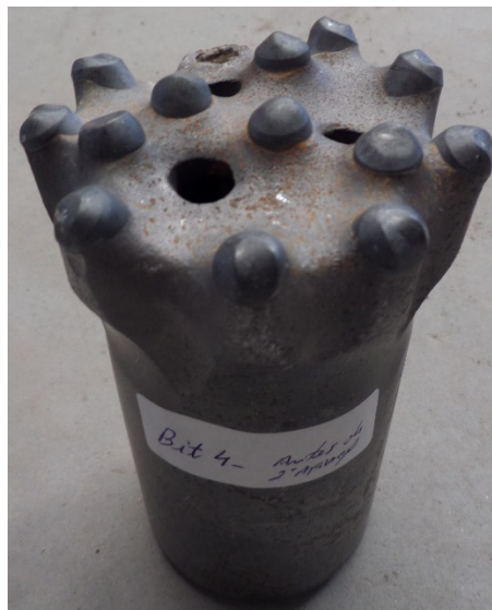
Figura 125. Bit 4, após 208 metros de perfuração acumulados.
