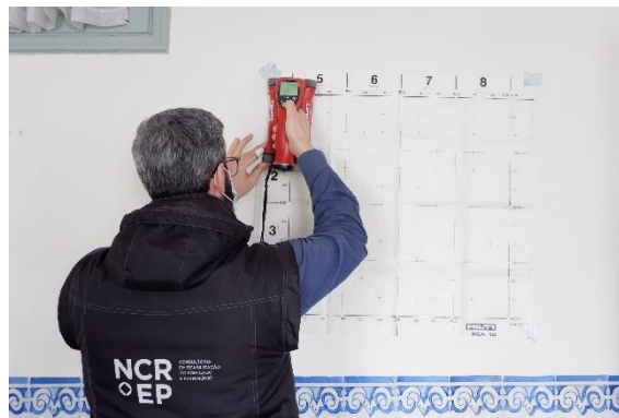
d) Ensaio com Ferroskan
