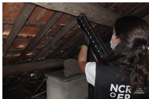
b) Ensaio com Resistograph
