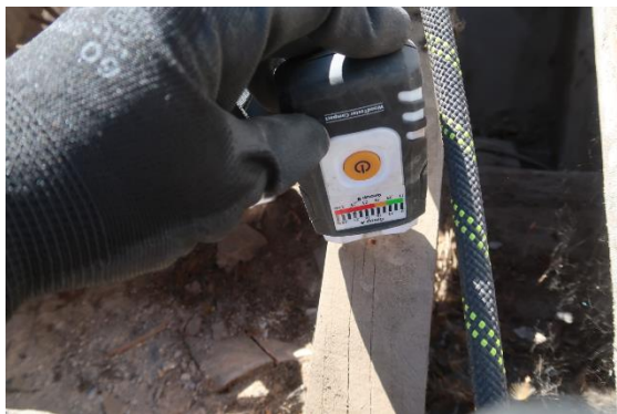
c) Medição do teor em água da madeira [11]
