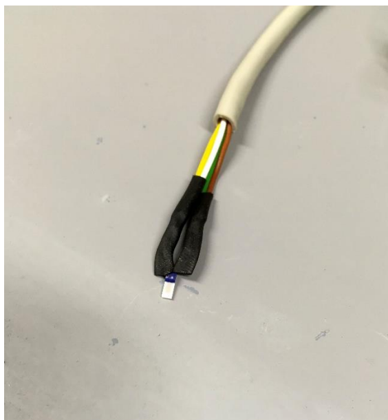
Figura 3.9 – Sensor de temperatura RTD
