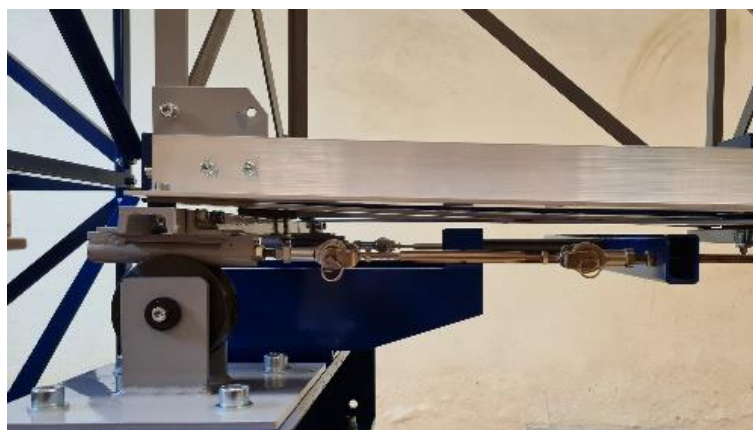
Figura 4.21 – Sistema de travamento do apoio na extremidade esquerda
