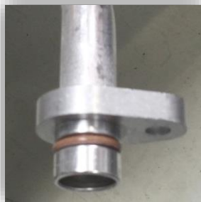
Figura 47 – Montagem de o'ring na AA29
