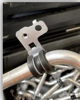
Figura 54 – Montagem de bracket na AA31
