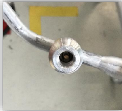
Figura 51 – Montagem do mecanismo de válvula na AA31
