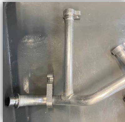
Figura 52 – Tubo não curvado na AA31
