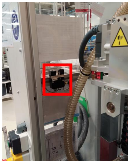
Figura 74 – Sensor para detetar o furo
