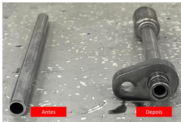
Figura 86 – Tubo normal e tubo embutido
