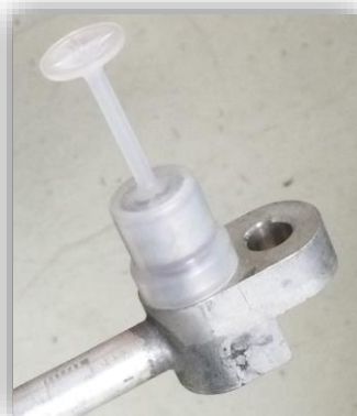
Figura 49 – Montagem de tampões na AA29
