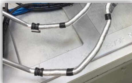
Figura 48 – Colocação de fita de cor na AA29
