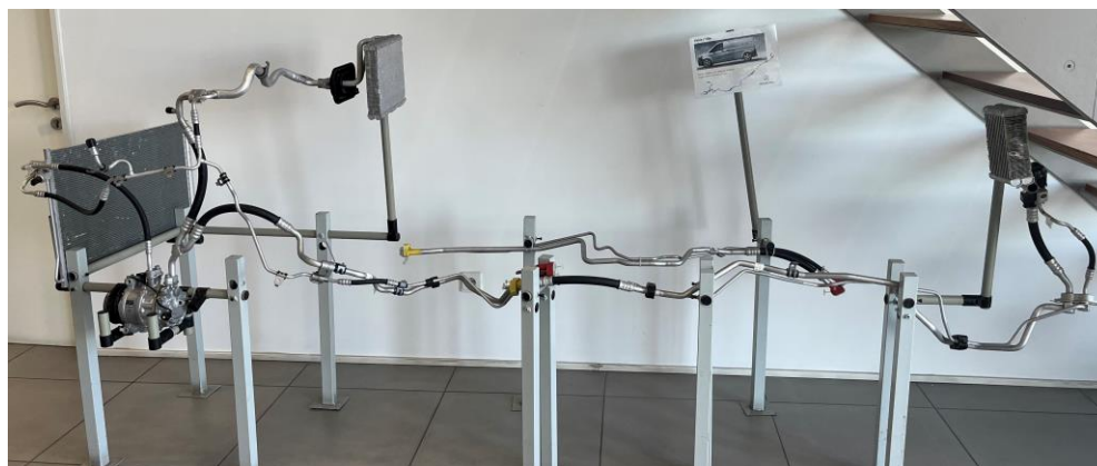
Figura 7 – Exemplo de sistema de ar condicionado
