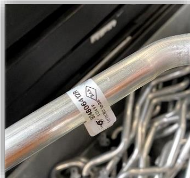
Figura 57 – Colocação de etiqueta de identificação na AA31
