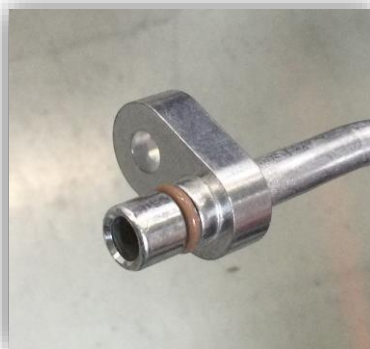
Figura 55 – Montagem de o'ring na AA31
