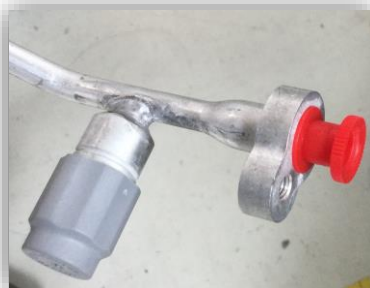
Figura 56 – Montagem de tampões na AA31
