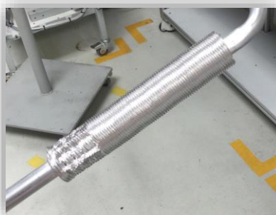
Figura 44 – Montagem de proteção de alumínio na AA29
