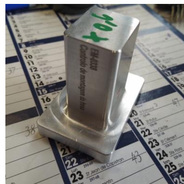
Figura 72 – “Passa” para verificar a altura da broca
