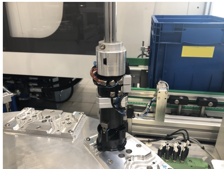
Figura 4.3: Epson G6 a pegar peça do ninho esquerdo com a sua garra
