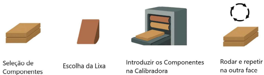
Figura 16 - Esquema do processo de Calibradora
