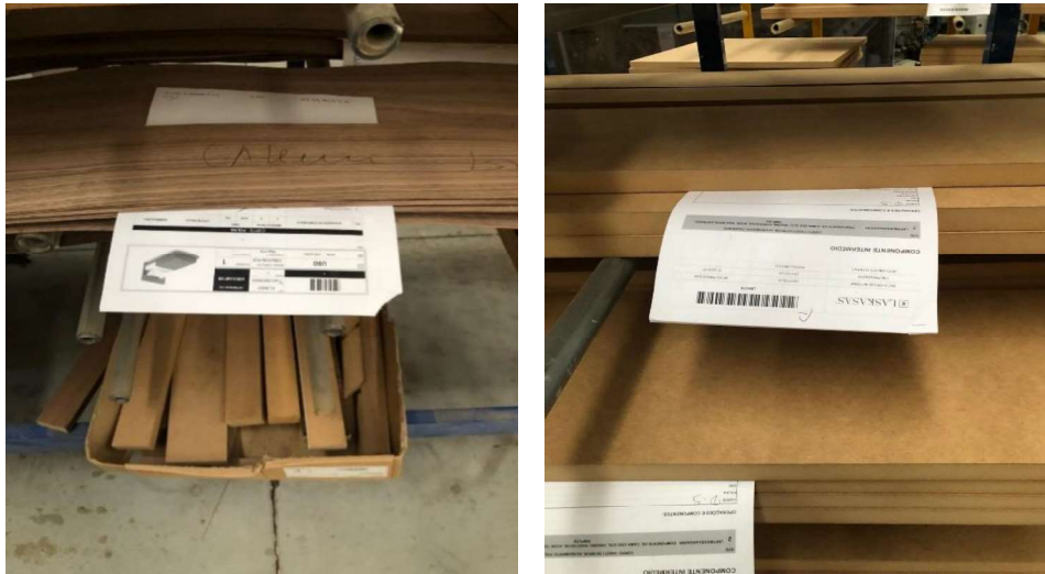
Figura 88 - Disposição dos processos nos carrinhos de WIP
