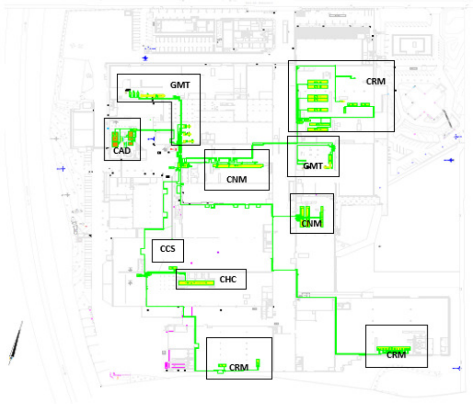
Figura 15 - Rede de termofluido da fábrica.
