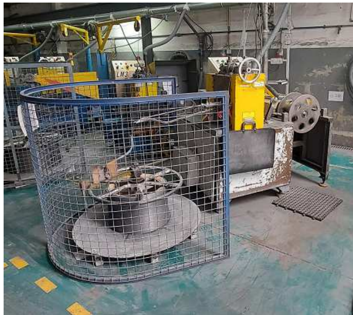
Figura 37 - Máquina Chinesa de Fabrico de Espiral Laminada (Ficocables, 2018)
