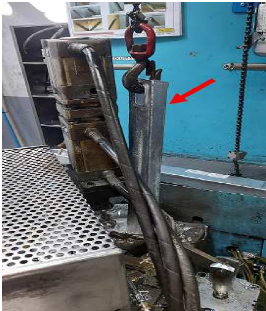
Figura 51 - Barra de Zamak na linha de injeção (Ficocables, 2020)
