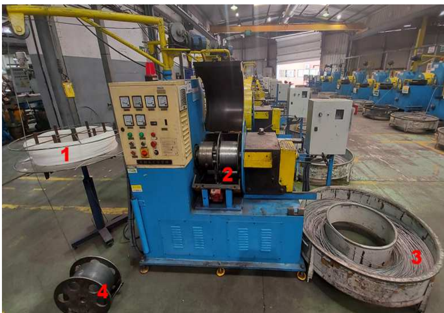
Figura 38 - Máquina Chinesa a conformar a espiral laminada (Ficocables, 2020)
