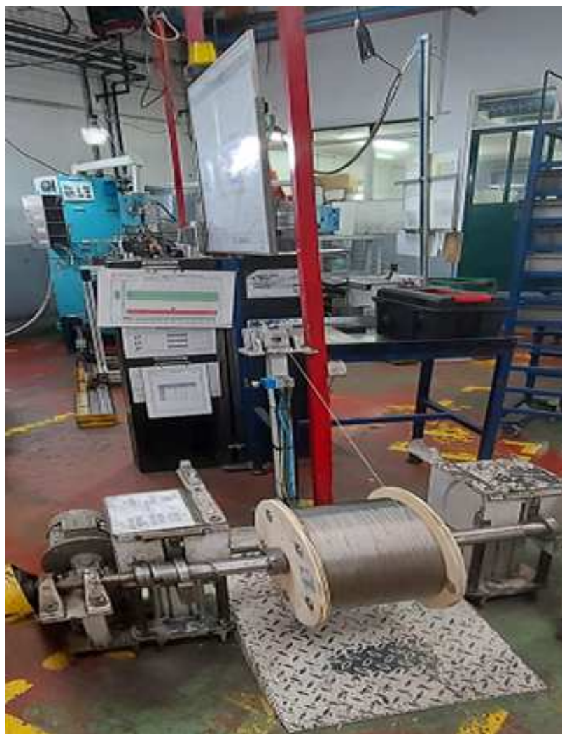
Figura 54 - Máquina automática de corte e injeção de Zamak (Ficocables, 2020)
