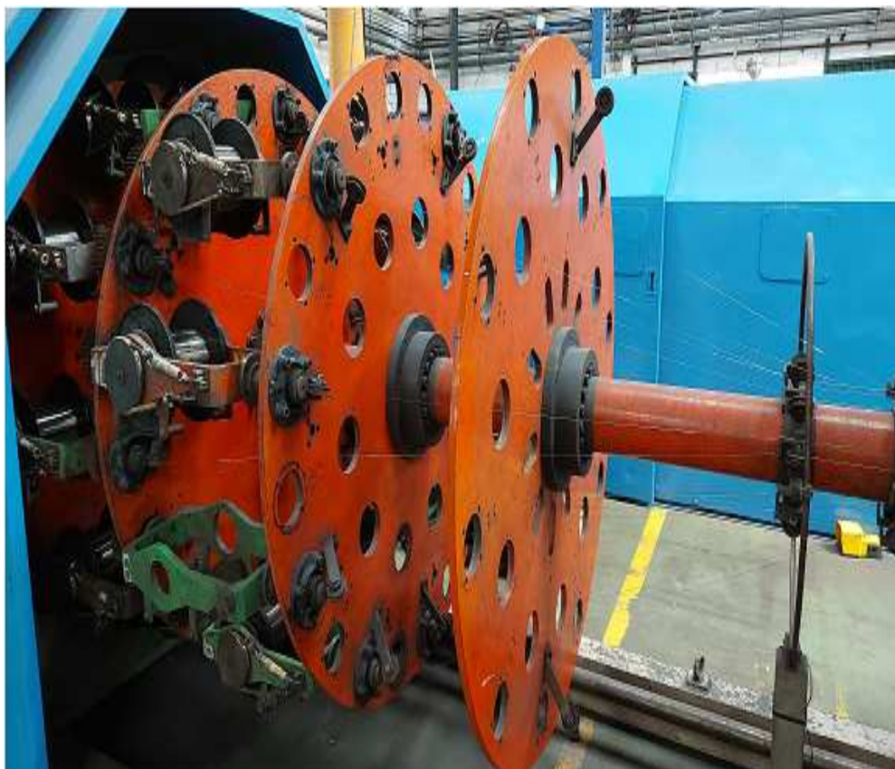
Figura 44 - Bobinas no interior da Máquina Planetária
