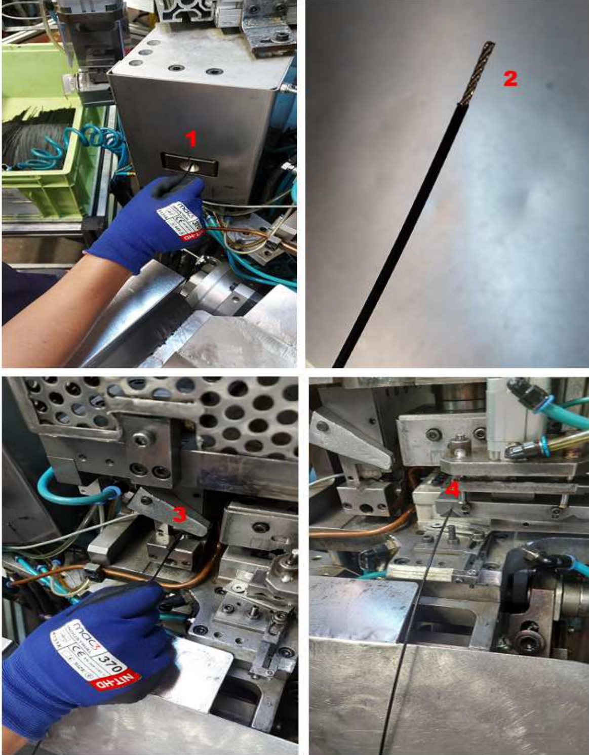
Figura 52 - Ilustração da Injeção Manual Cabos Exteriores (Ficocables, 2020)
