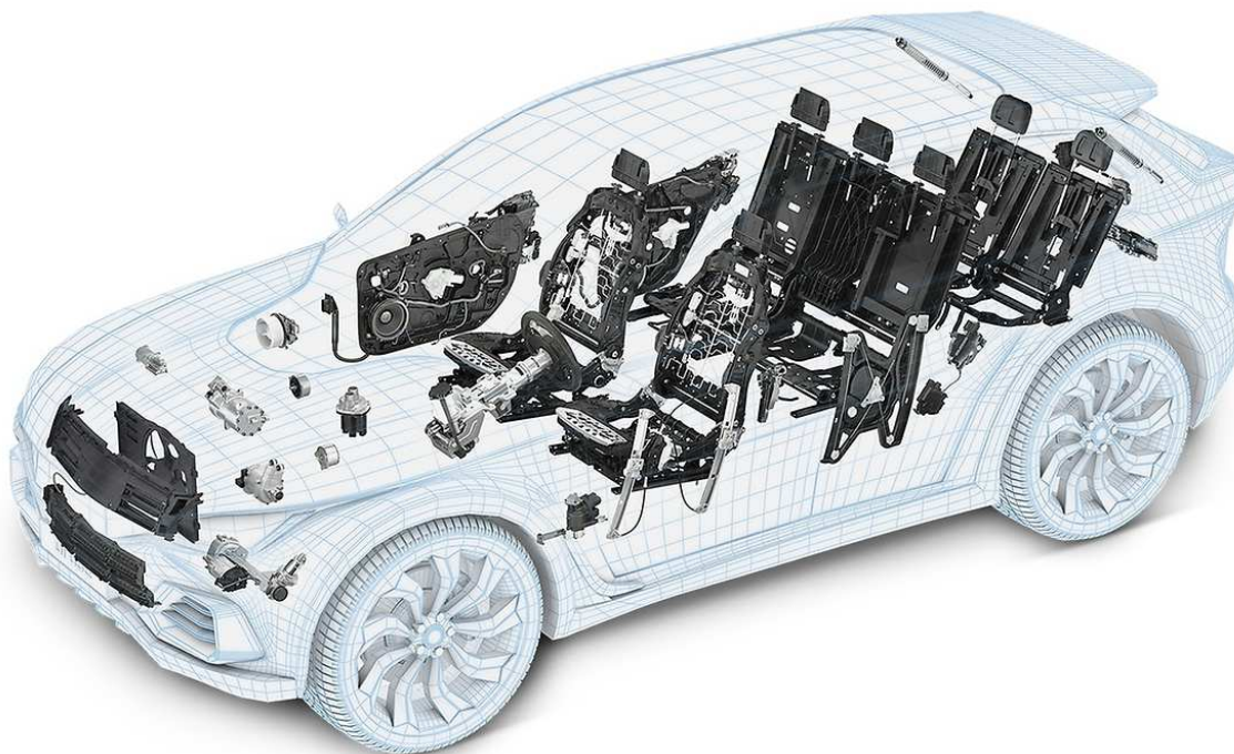
Figura 29 - Diferentes aplicações de cabos de comando no interior de um automóvel (Brose, 2020)
