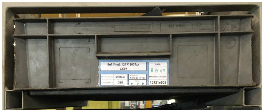
Figura 79 - Etiqueta Kanban afixada na caixa
