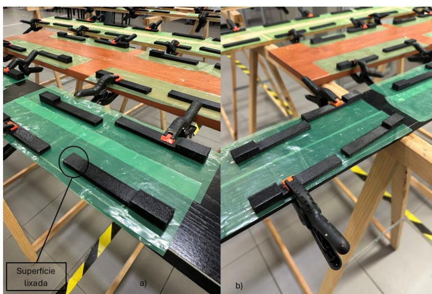
Figura 24 - Fabrico de provetes: a) Superfície lixada no provete; b) provete em gabarit
