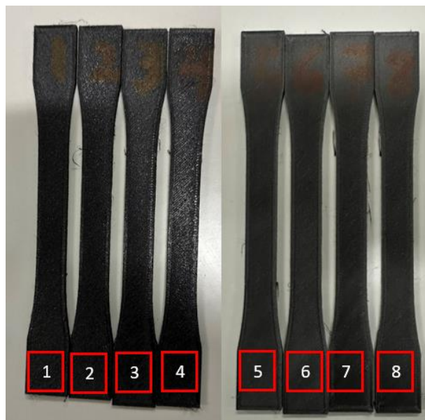
Figura 17 - Provetes bulk (1-4 provetes em PA s/FC, 5-8 provetes em PA c/FC)
