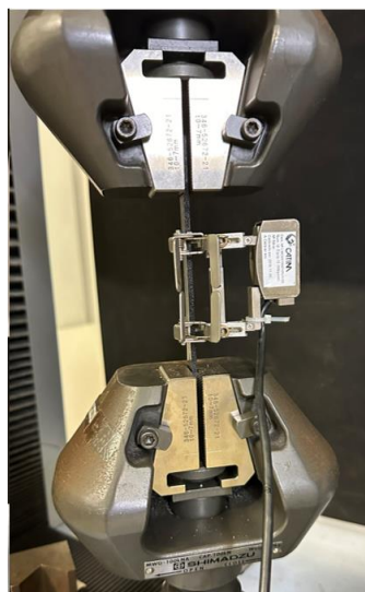
Figura 19 - Provete com extensómetro durante ensaio de tração
