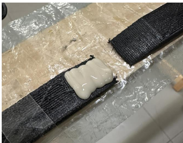
Figura 26 - Aplicação do adesivo
