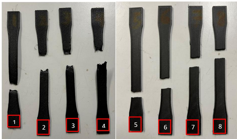
Figura 20 - Modos de rotura dos provetes bulk
