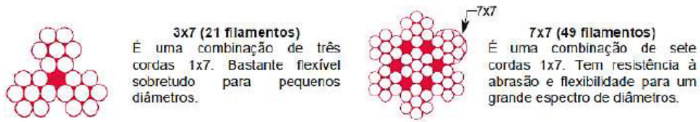
Figura 23 - Exemplos de seções de cabo com mais do que um núcleo [60]
