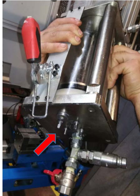
Figura 123 - Verificação do funcionamento do sistema de vedação
