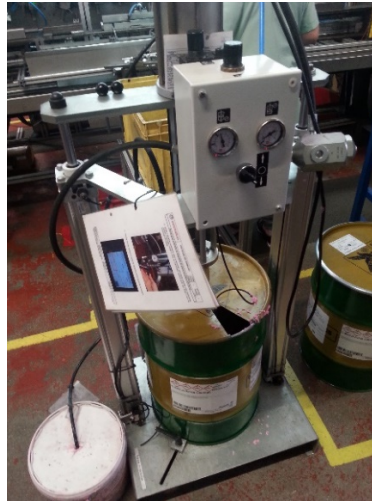
Figura 42 - Sistema de enchimento fixo na linha
