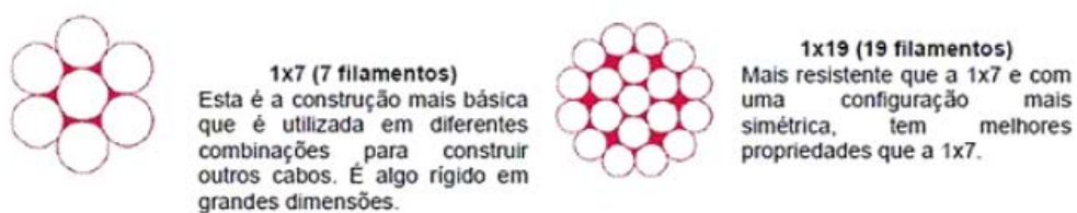
Figura 22 - Exemplos de seção de cordas ou cabos
