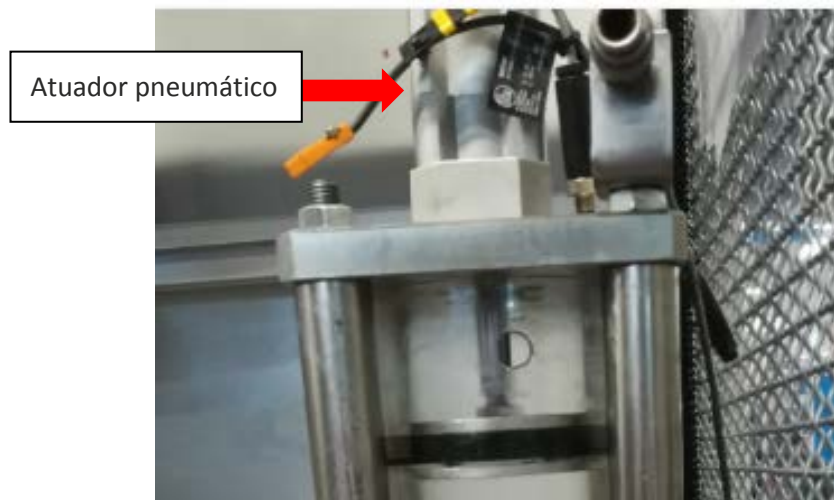
Figura 57 - Sistema pneumático do reservatório
