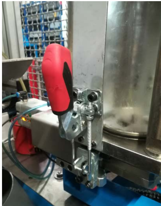
Figura 122 - Fixação por grampos do reservatório
