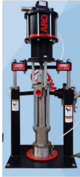
Figura 27 - Bomba de extração de lubrificante com mecanismo próprio [67]
