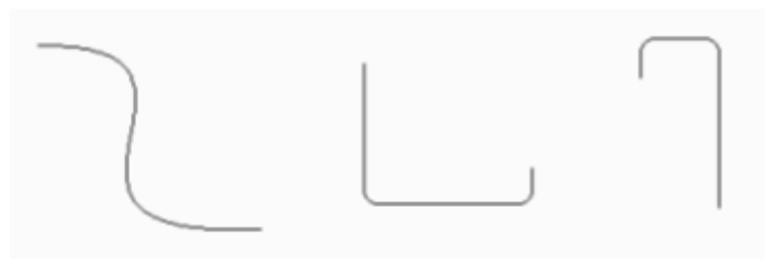
Figura 19 - Layouts possíveis dos cabos metálicos [60]
