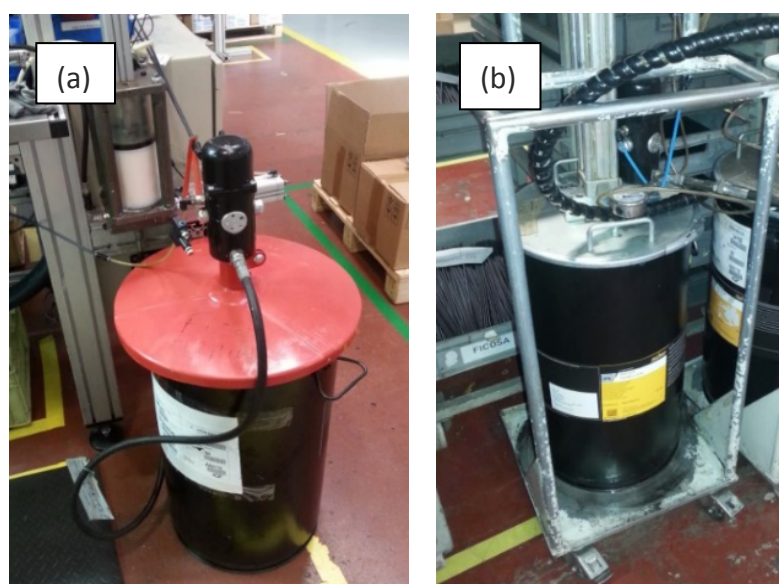
Figura 32 - Sistema de enchimento fixo na linha (a) e Sistema móvel (b)
