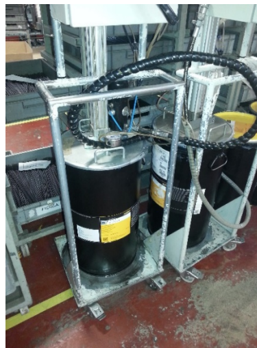
Figura 43 - Sistema de enchimento móvel
