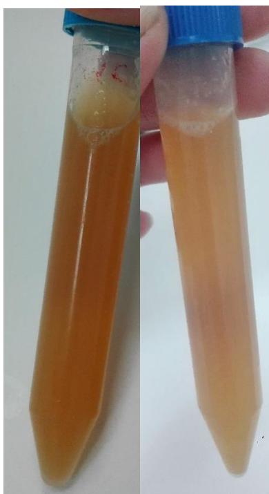
Figura 7: Extrato de maçãs de qualidade conforme. a) homogeneização com água destilada; b) homogeneização com NaCl.
