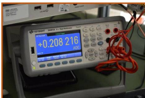
Figura 34 - Valor da corrente elétrica (A) em curto-circuito
