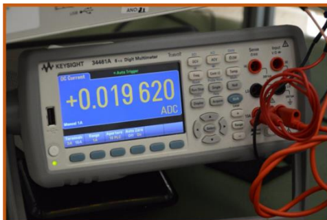
Figura 32 - Valor da corrente elétrica (A) sem qualquer tipo de partícula condutora
