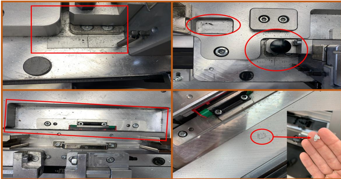
Figura 42 - Diferentes tipos de contaminação encontrados nos carrinhos
