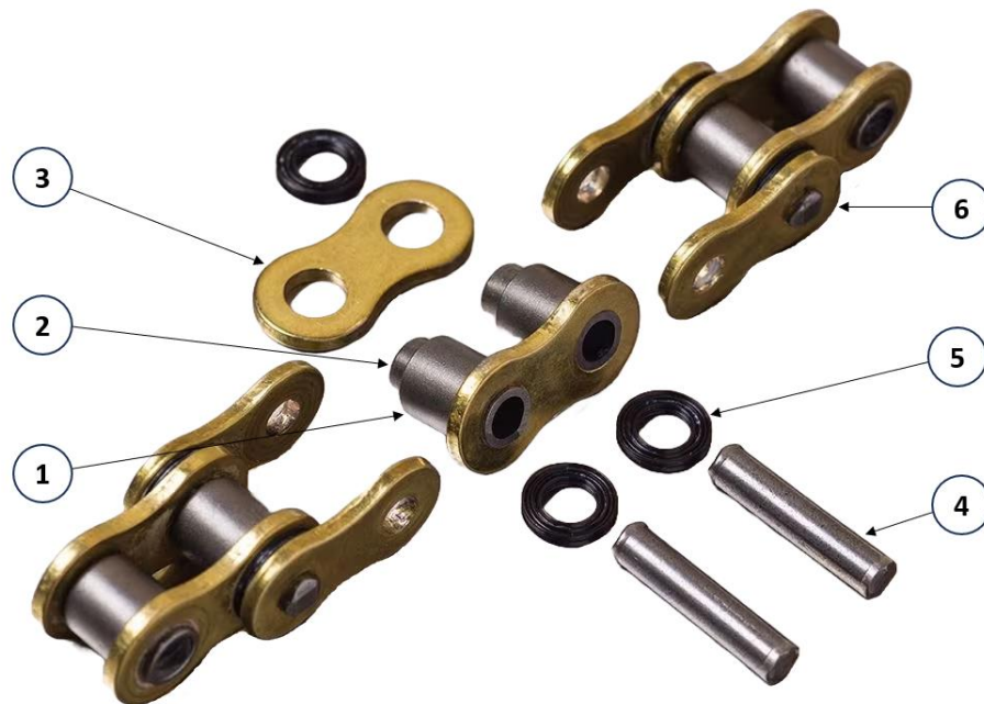
Figura 23 - Representação parcial de uma corrente, adaptado de (Henning, 2020), onde 1) Rolo; 2) Casquilho; 3) Placa interior; 4) Pino; 5) Vedante; 6) Placa exterior
