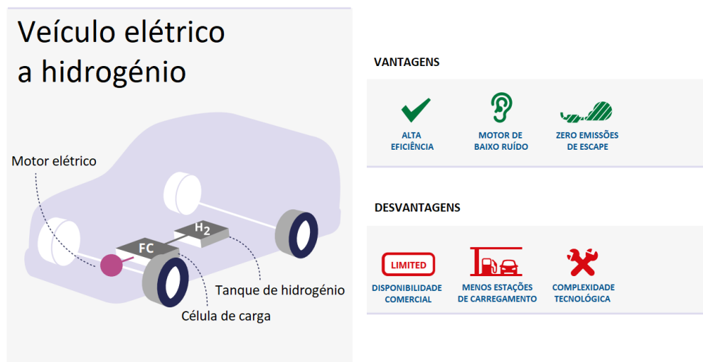
Figura 8 - Configuração genérica de um veículo elétrico a hidrogénio e respetivas vantagens e desvantagens, adaptado de (European Environment Agency., 2016)
