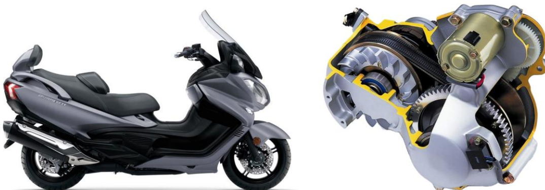
Figura 19 - Suzuki Burgman 650 Executive (à esquerda), adaptado de (Andar de Moto, n.d.), e respetiva caixa de velocidades (à direita), adaptado de (MCS, n.d.)
