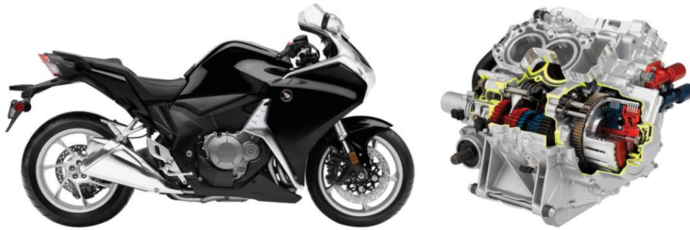
Figura 15 - Honda VFR1200F (à esquerda), adaptado de (Gheran & Profir, 2023), e respectiva caixa de velocidades (à direita), adaptado de (Lee, 2021)
