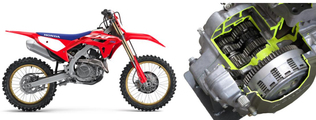
Figura 13 - Honda CRF450R (à esquerda), adaptado de (Mototrofa, n.d.), e respetiva caixa de velocidades (à direita), adaptado de (TeamZilla, 2020)
