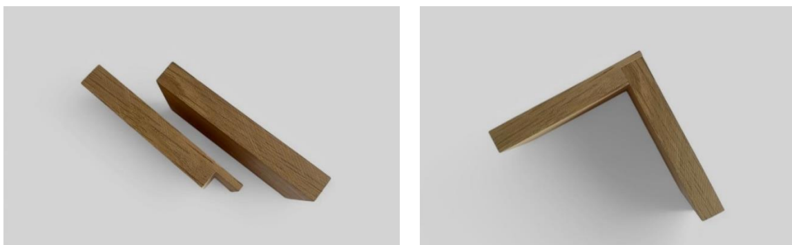
Figura 104 e Figura 105 - Detalhes da Junta de Sobreposição.
