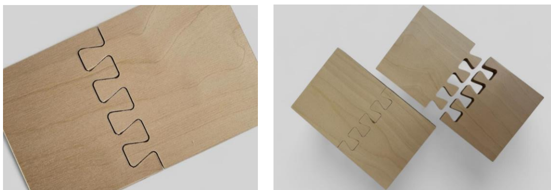
Figura 106 e Figura 107 - Estudos de Tolerâncias da Junta de Cauda de Andorinha Sobreposta.
