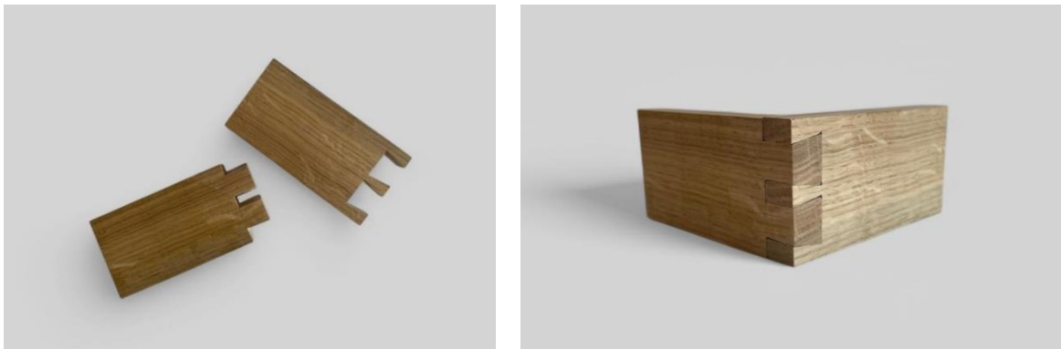
Figura 61 e Figura 62 - Junta de Cauda de Andorinha - Execução Manual.
