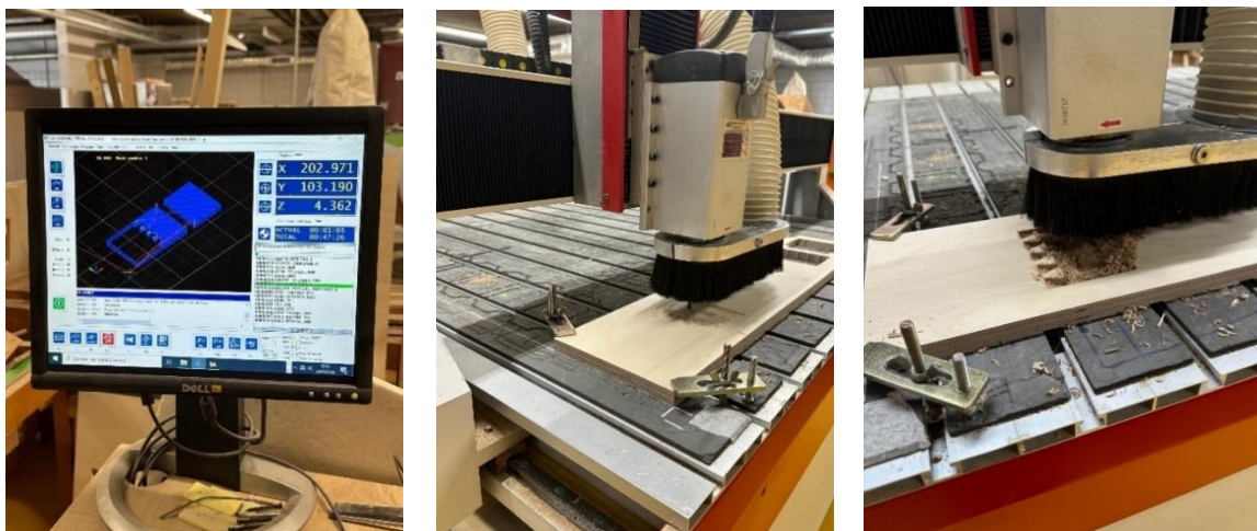
Figura 83, Figura 84 e Figura 85 - Processo de Execução Mecanizada da Junta de Cauda de Andorinha Sobreposta.
