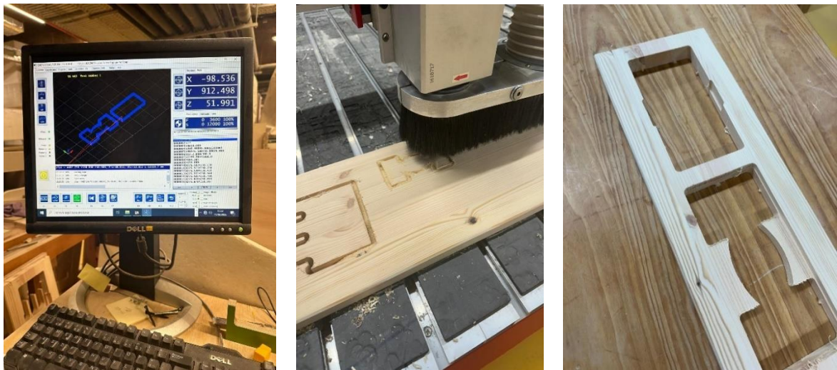
Figura 93, Figura 94 e Figura 95 - Processo de Execução Mecanizada da Junta de Furo Aberto e Espiga.
