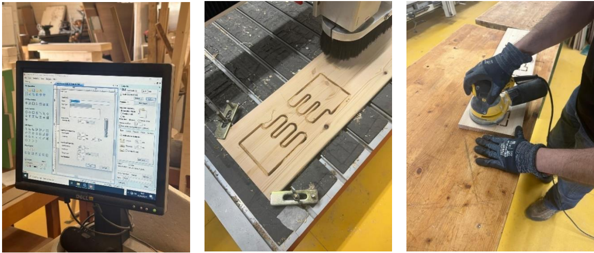
Figura 88, Figura 89 e Figura 90 - Processo de Execução Mecanizada da Junta de Dedo.
