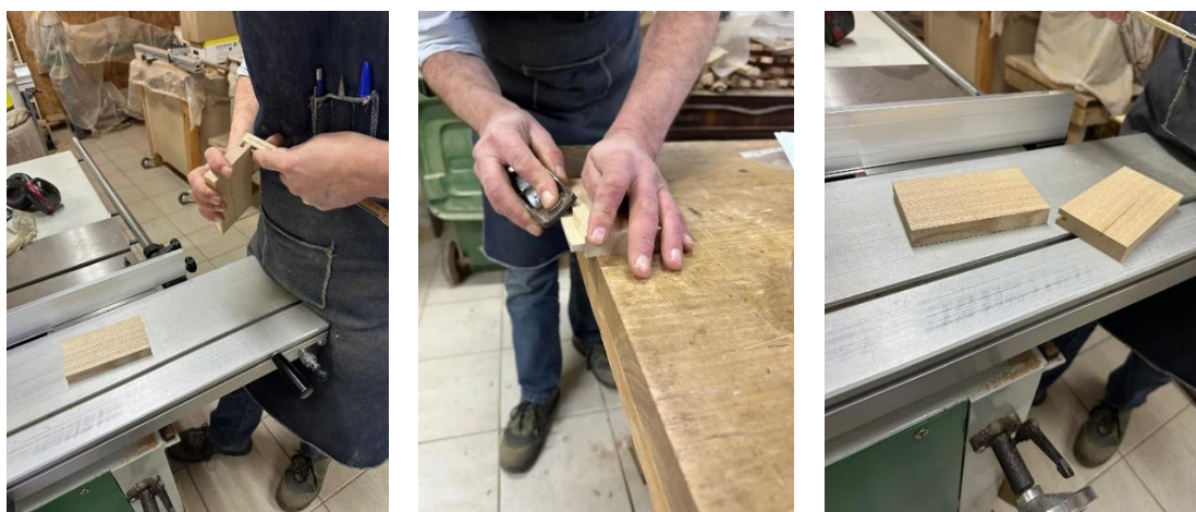
Figura 68, Figura 69 e Figura 70 - Processo de Execução Manual da Junta de Macho e Fêmea.
