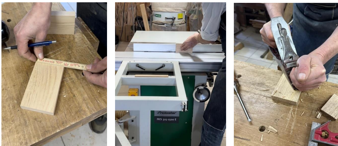
Figura 73, Figura 74 e Figura 75 - Processo de Execução Manual da Junta de Sobreposição.
