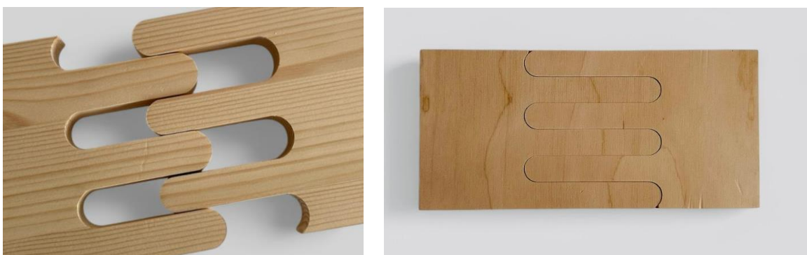
Figura 110 e Figura 111 - Estudo de Tolerâncias da Junta de Dedo.
