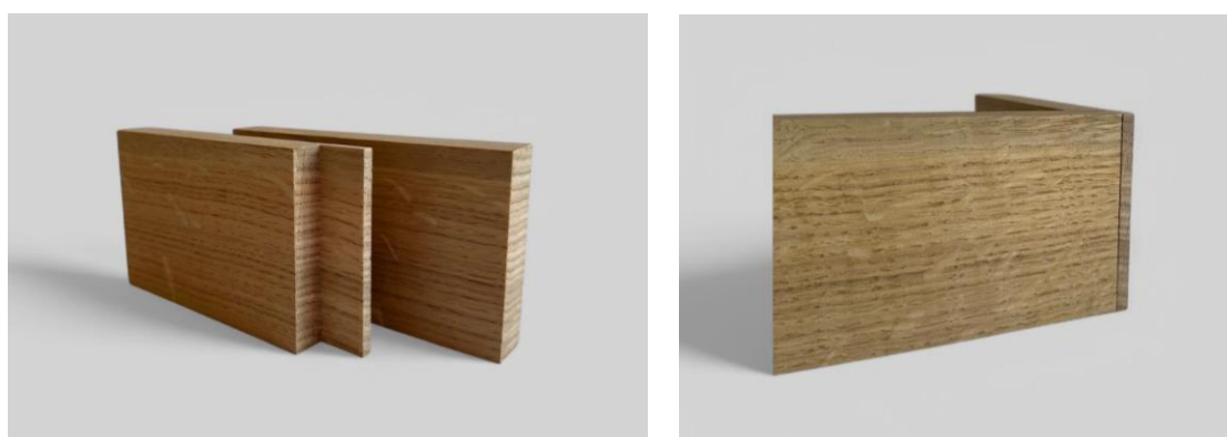
Figura 76 e Figura 77 - Junta de Sobreposição - Execução Manual.
