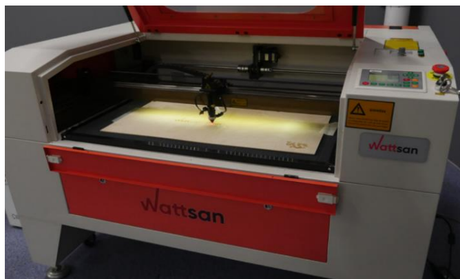
Figura 30 - Máquina de gravação e corte a laser. Virmer. 2022. What is a laser engraving machine for wood.
