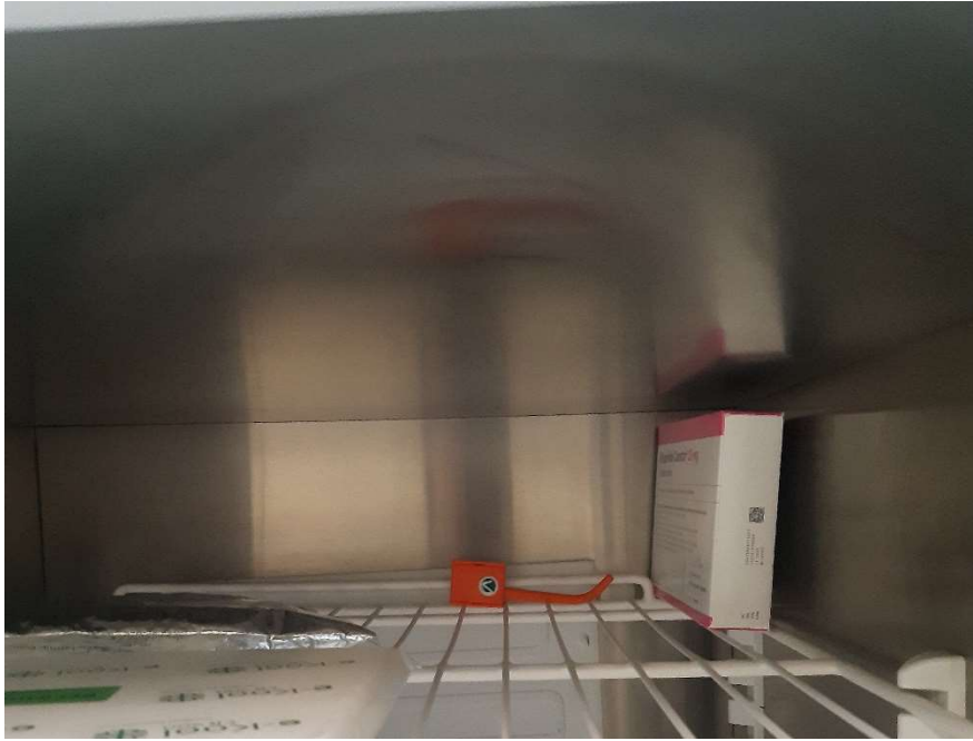
Figura 12 - Sensor SENSEANYWHERE que mede a temperatura, pertencendo aos Serviços Farmacêuticos do HML. Este mede a temperatura de um frigorífico com medicação.
