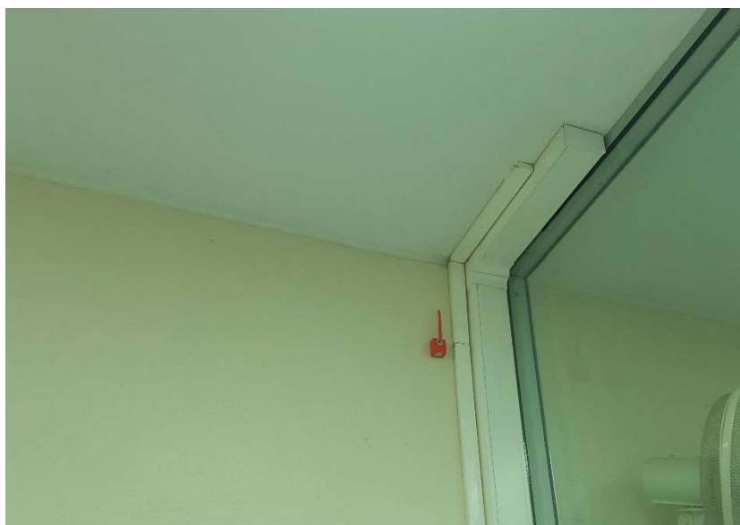
Figura 11 – Sensor SENSEANYWHERE que mede a temperatura e a humidade relativa, pertencendo aos Serviços Farmacêuticos do HML. Este mede as condições ambientais da sala.
