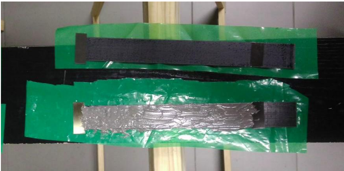
Figura 48 - Adesivo estrutural Araldite® AV138 aplicado no aderente [81].
