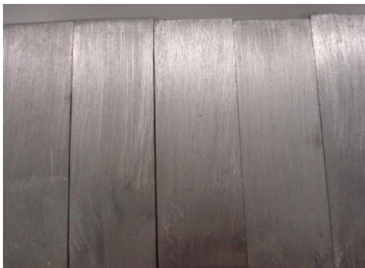
Figura 46 - Superfície do aderente metálico após a lixagem e limpeza [81].
