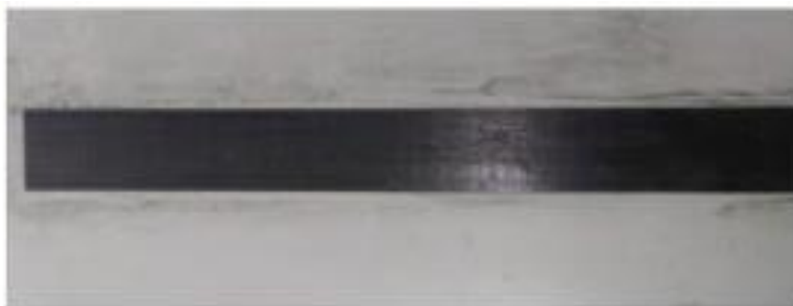
Figura 45 - Resultado do processo de preparação superficial do compósito laminado [81].
