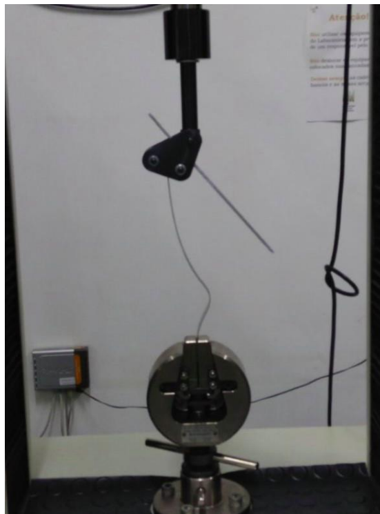
Figura 51 - Configuração final do provete ao fim do ensaio floating roller peel [81].
