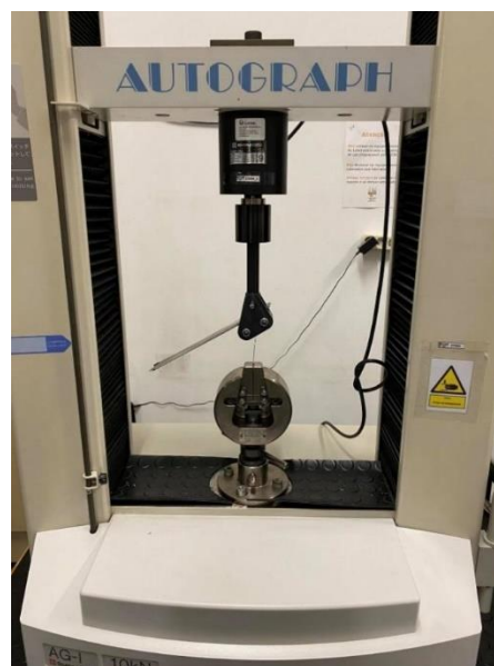
Figura 50 - Configuração inicial do provete para o ensaio de arrancamento.
