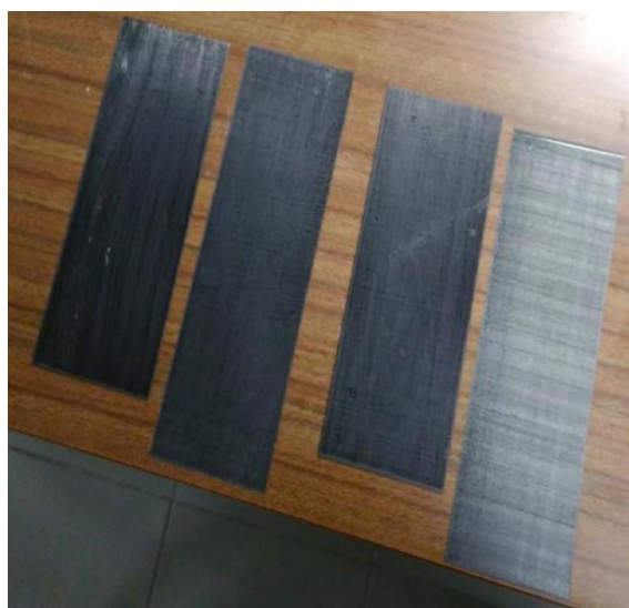
Figura 44 - Geometria do laminado PRFC após o corte [81].
