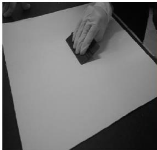
Figura 42 - Direção da pressão aplicada nas camadas de pré-impregnado [81].
