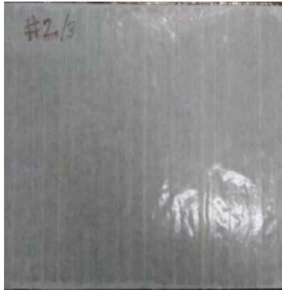
Figura 41 - Proteção plástica do pré-impregnado [81].
