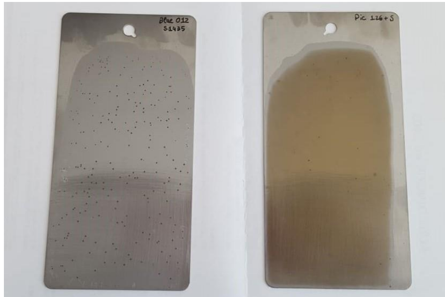
Figura 4.1 – Ocorrência da corrosão instantânea na resina R8 e resina R12, respetivamente.
