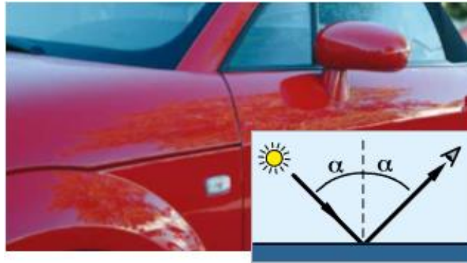
Figura 3.3 – Reflexão da luz numa superfície brilhante [23].
