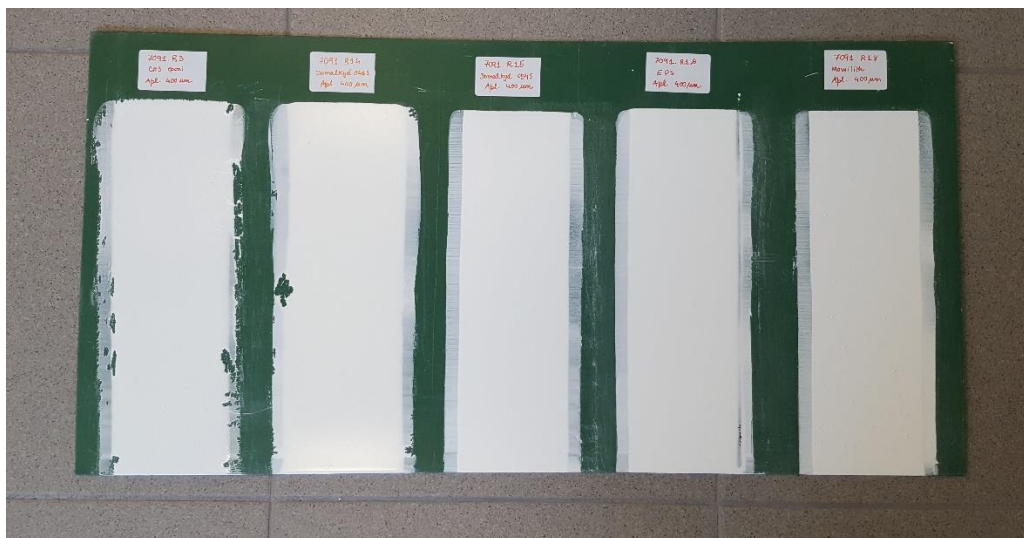
Figura 3.8 - Aplicação para estudo da absorção de água através das diferentes resinas.
