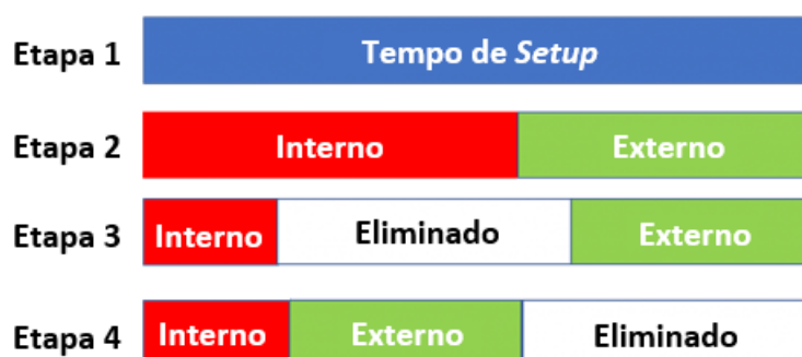
Figura 30 - Esquema representativo das etapas do SMED , adaptado de Shingo (1985).
