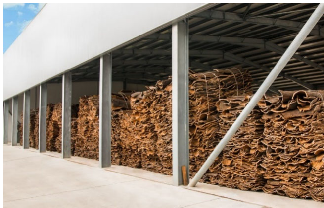
Figura 9 - Estabilização da cortiça após processo de cozedura.
