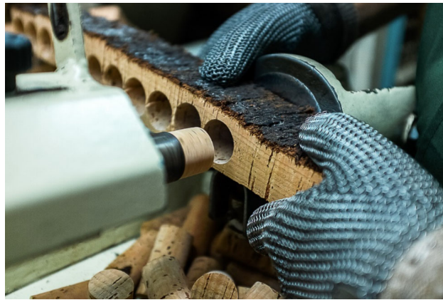
Figura 12 - Processo de brocagem.
