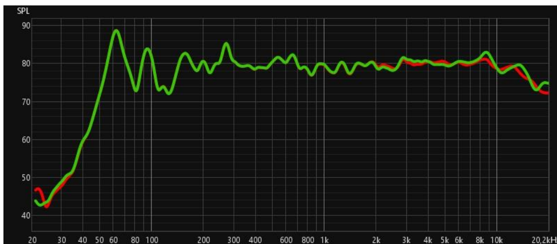
Fig. 21 – Comparação da Resposta Frequencial do Microfone ECM8000 sem Cápsula e com Cápsula de Proteção sem Material Poroso.
