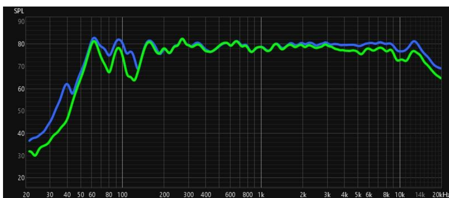
Fig. 29 – Comparação da Resposta Frequencial do AKG CK91 com Revestimento em Material de Máscara Descartável Aplicado na Cápsula de Proteção.
