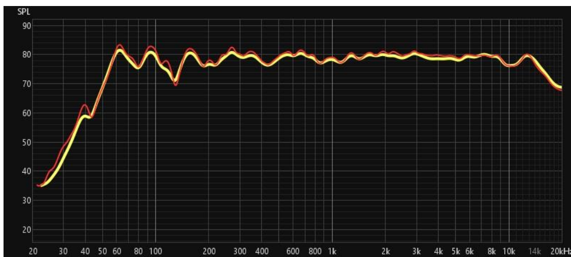
Fig. 31 – Comparação da Resposta Frequencial da Espuma de Poliuretano Aplicada na Cápsula de Proteção e em Configuração Convencional.
