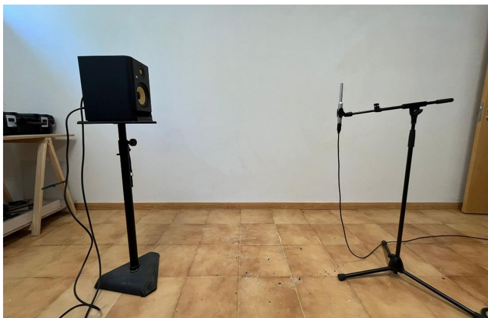
Fig. 18 – Configuração Experimental Utilizada nos Ensaio Comparativos em REW, com Altifalante de Referência e Microfone de Medição.
