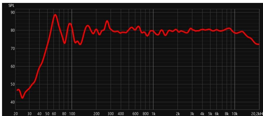
Fig. 19 – Resposta Frequencial da Oficina Utilizada nos Ensaio Acústicos, Obtida através do Microfone de Medição ECM8000.
