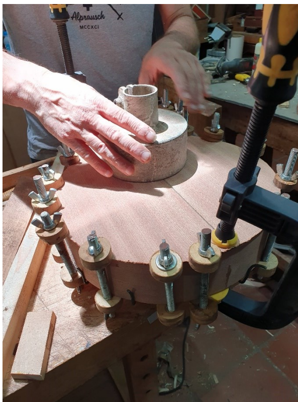
Figura 63 - Colagem do fundo com auxílio de grampos
