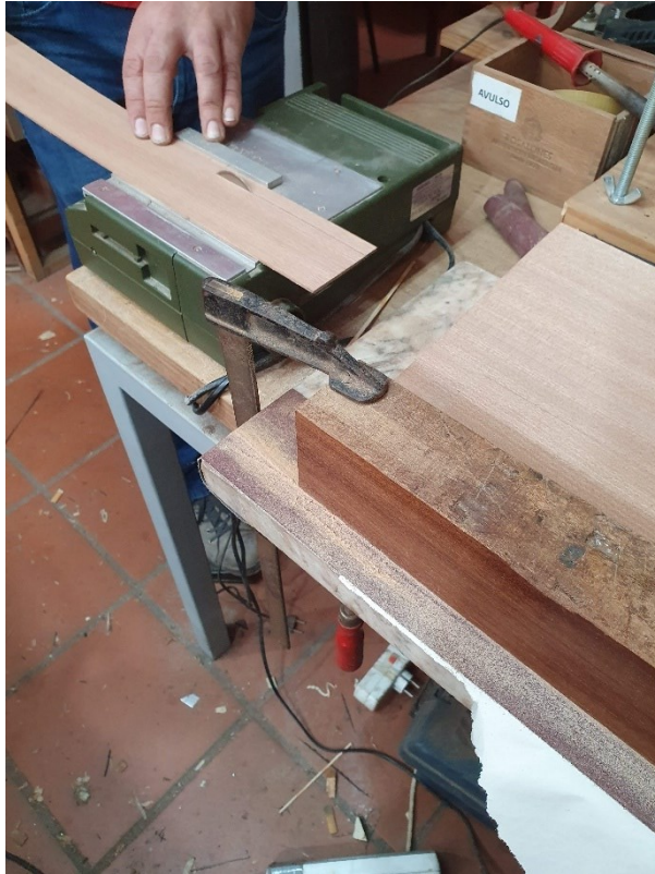
Figura 56 - Corte da madeira para os cerquilhos
