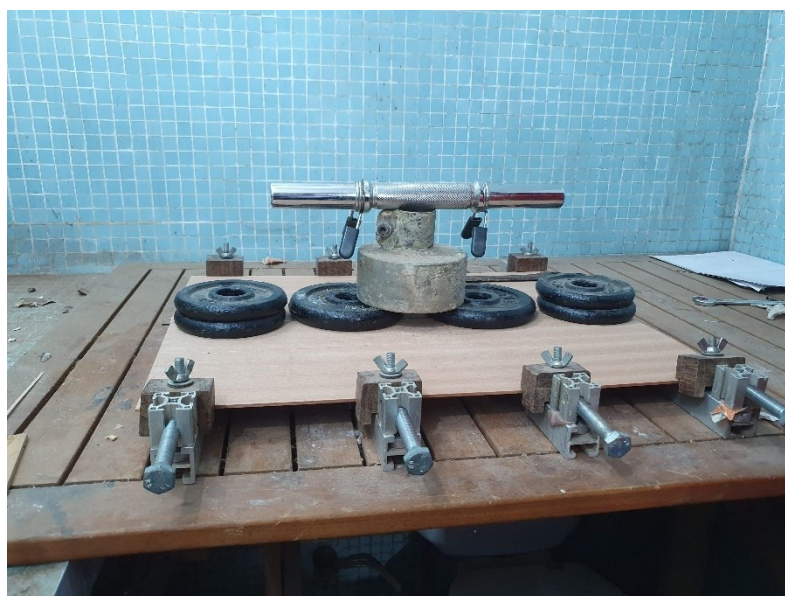
Figura 55 - Colagem das metades para o fundo
