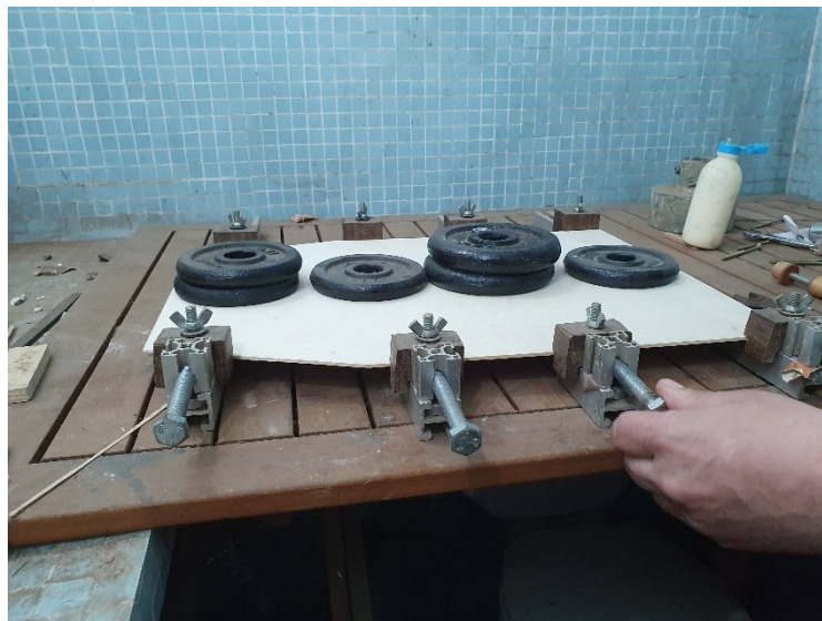
Figura 50 - Colagem das metades para o tampo
