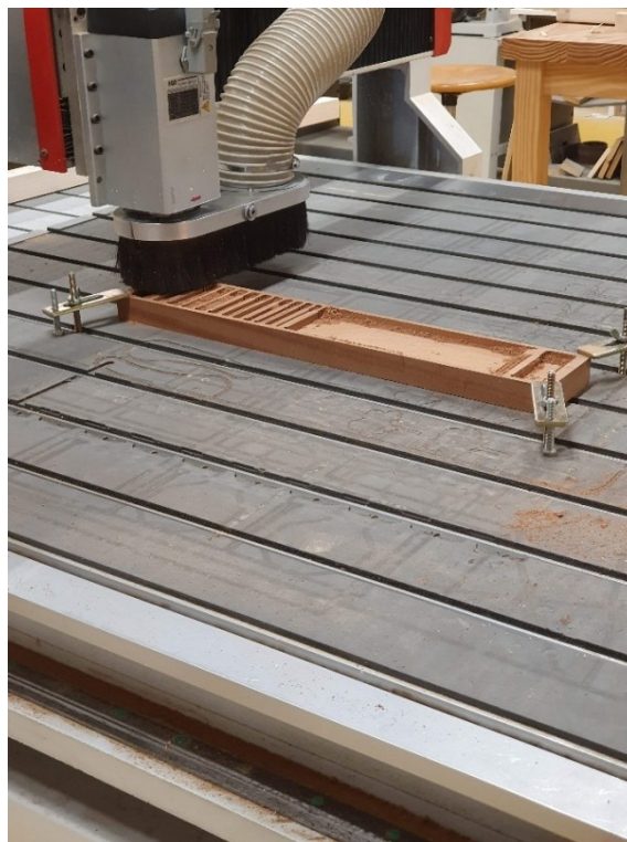
Figura 42 - Corte do braço em CNC
