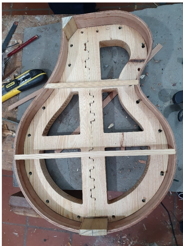
Figura 60 - Colagem das travessas nos cerquilhos
