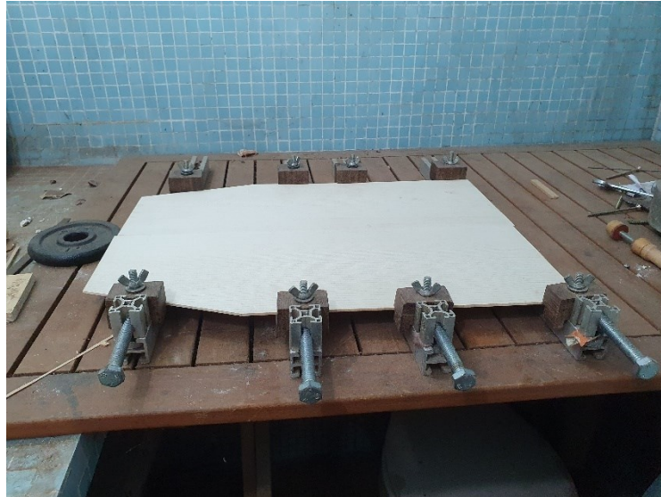
Figura 49 - Colagem das metades para o tampo
