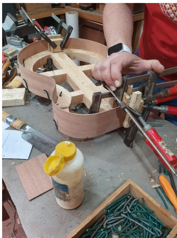
Figura 54 - Colocação dos grampos após a colagem das ilhargas
