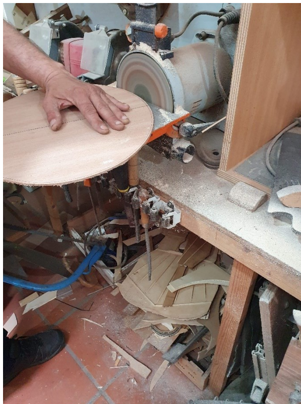
Figura 62 - Retificação do corte do fundo
