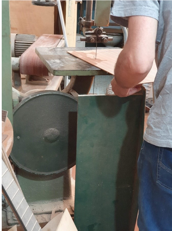
Figura 61 - Corte do fundo com a serra de fita
