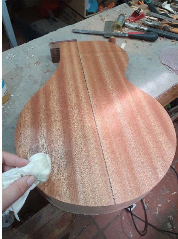
Figura 77 - Aplicação da goma-laca no fundo
