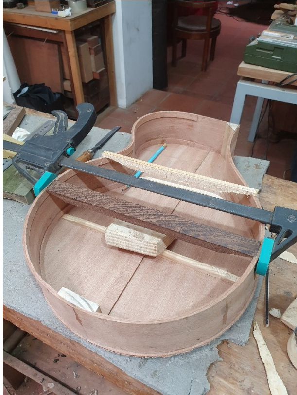
Figura 66 - Colagem e medição das travessas para o tampo
