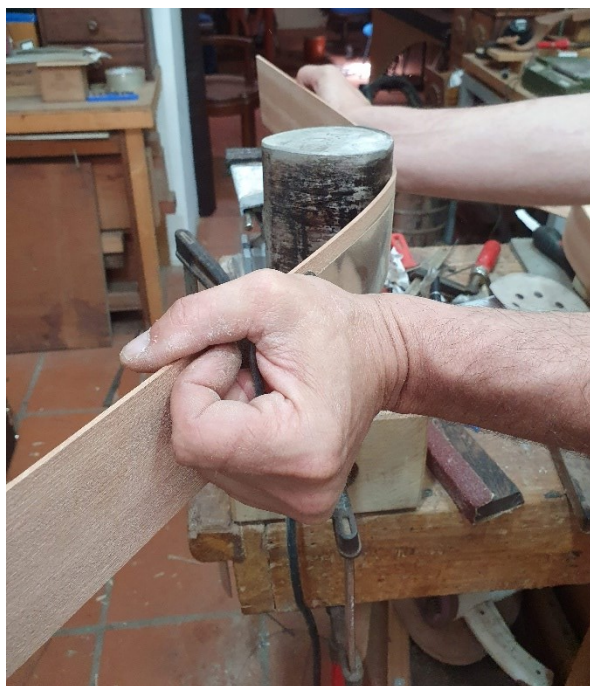
Figura 52 - Dobragem das ilhargas com o farol
