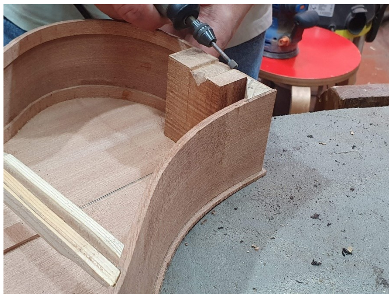
Figura 71 - Escavação para embutir a peça de metal
