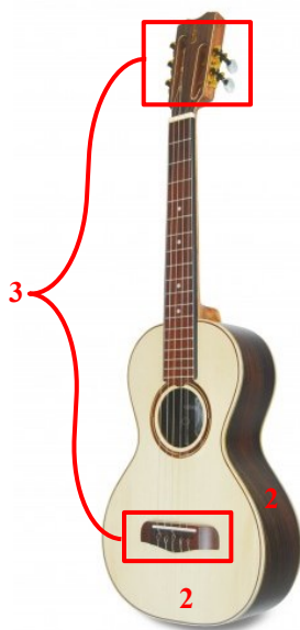
Figura 1 - Esquema ilustrativo da caixa de ressonância (2) e dos pontos de fixação das cordas (3)
