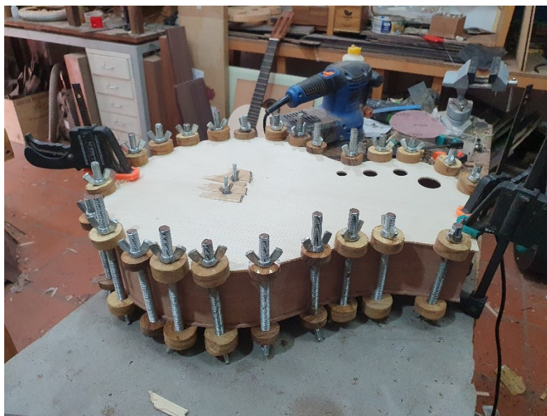
Figura 73 - Colagem do tampo
