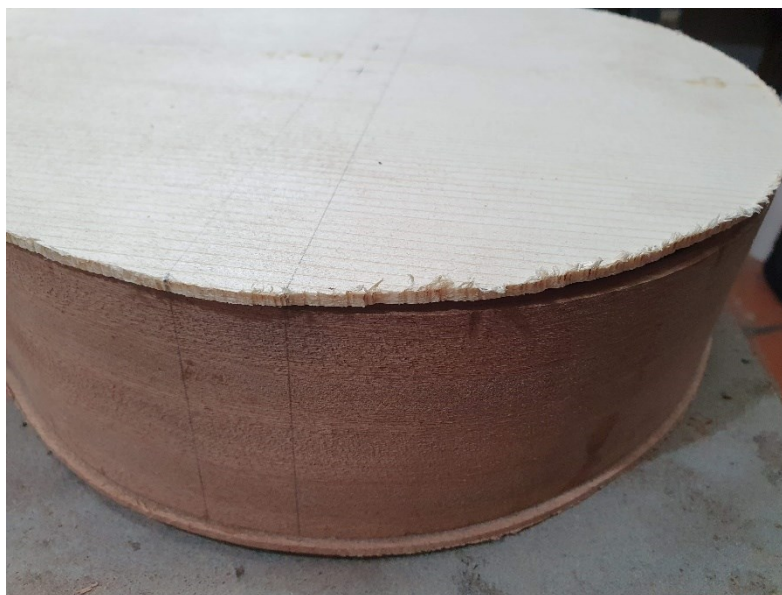
Figura 68 - Marcação do local onde passa a travessa para o encaixe com o tampo
