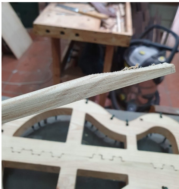
Figura 58 - Curvatura na ponta da travessa
