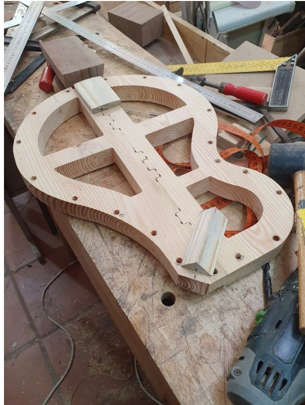
Figura 48 - Molde para as ilhargas com as duas peças de união
