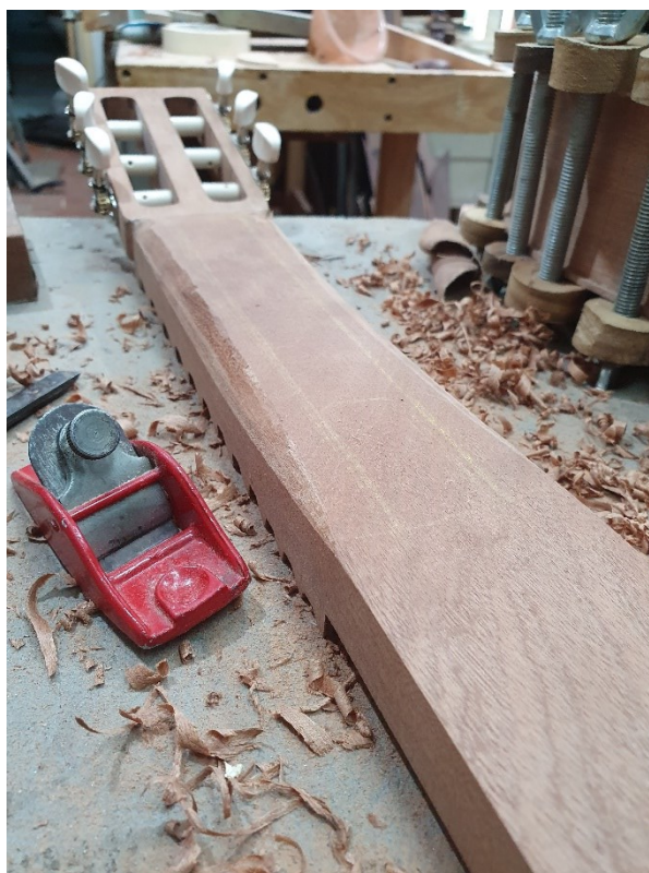
Figura 74 - Retificação do braço
