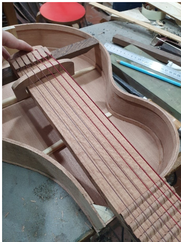
Figura 67 - Referência do braço para as travessas
