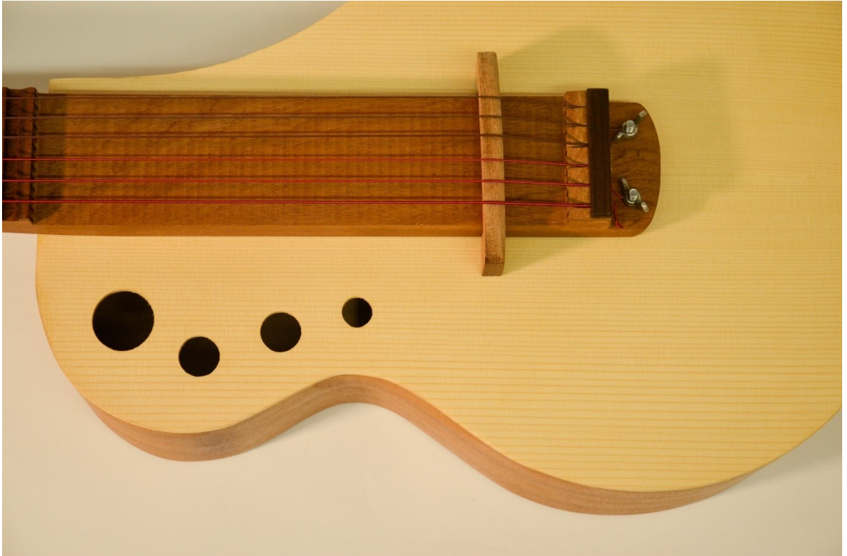
Figura 87 - Pormenor das furações no tampo e encaixe
