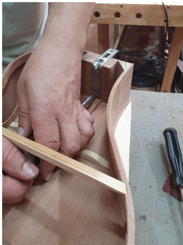
Figura 70 - Fixação da peça para o encaixe na zona da ilharga
