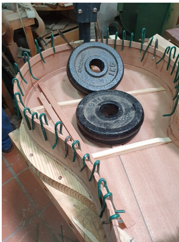
Figura 65 - Colagem dos cerquilhos na parte superior da ilharga
