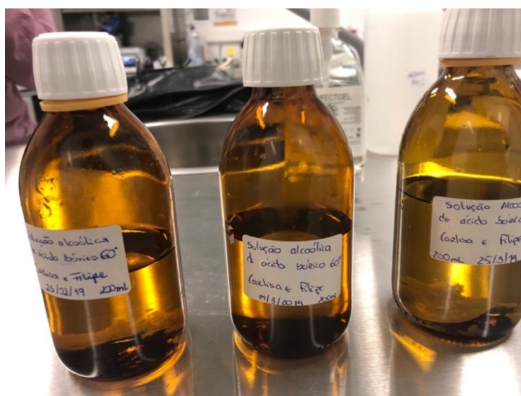
Figura 5 Aspeto das soluções após formação de precipitado (da esquerda para a direita: solução 1, solução 2 e solução 3)
