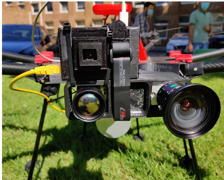
(b) STORK com sistema low-cost IR (em cima), TELEDYNE Dalsa Calibri GX (em baixo do sistema low-cost IR ) e uma câmara visível (à direita).
