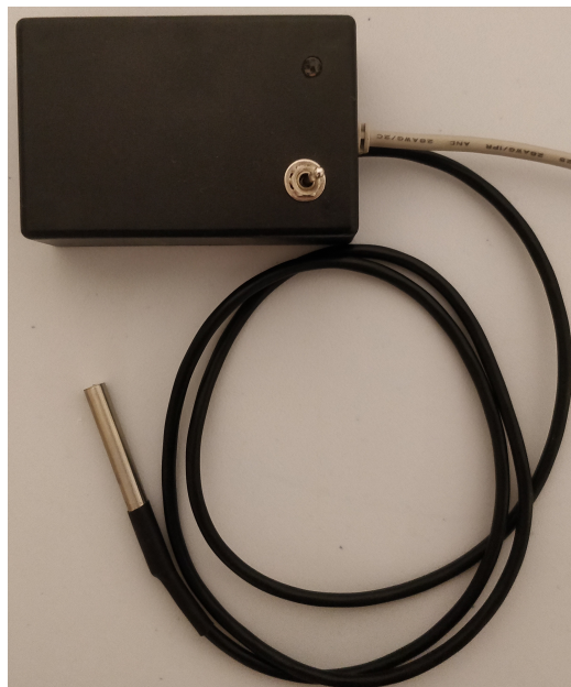
Figura 6.1: Sensor de temperatura submersível DS18B20.
