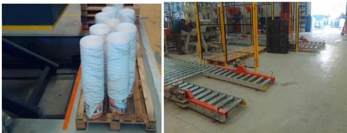
Figura 56 - Bordos de Linha de Retirada nas zonas de Enchimento de Tintas Plásticas.
