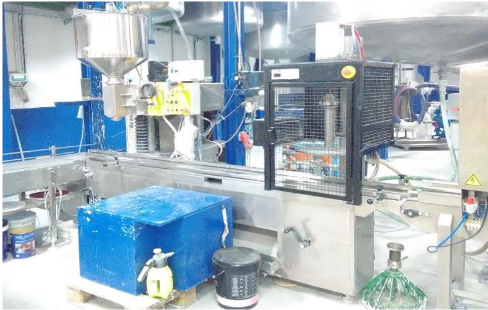
Figura 27 – Enchedora de Tintas Plásticas.
