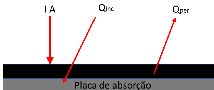
Figura 12 – Balanço energético típico de um coletor solar.
