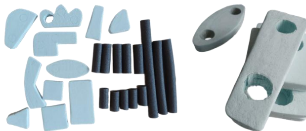
Figura 128 e 129: Corte de peças em XPS e em tubo em polietileno, para encaixe (imagens da autoria da autora)
