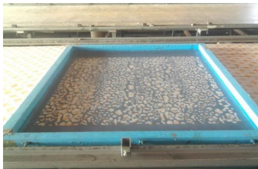
Figura 2.3. Quadro plano usado na estamparia têxtil [6]
