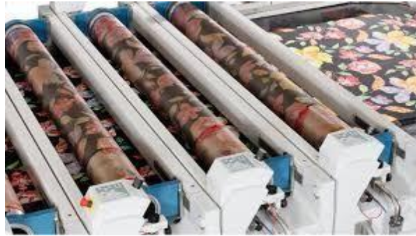
Figura 2.2. Quadro rotativo usado na estamparia têxtil [5]
