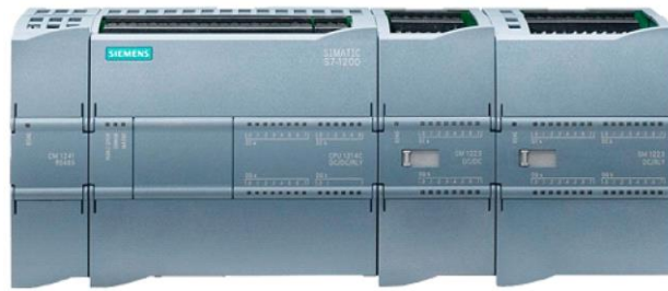
Figura 55 - Controlador básico SIMATIC S7-1200 [84]
