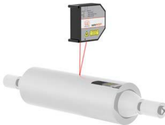
Figura 29 - Utilização de transdutores laser [48]
