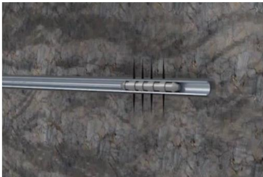
Figura 66. Perfurador e fendas na formação rochosa, (adaptado de: “Fracking: Everything You’ve Always Wanted to Know”, munknee.com).
