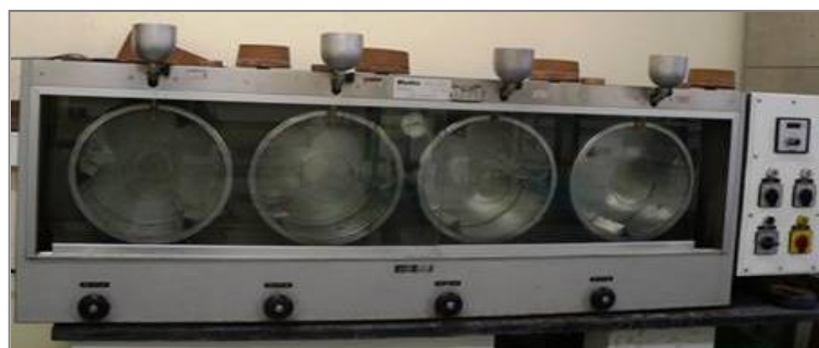
Figura 3.4- Equipamento utilizado no tratamento da pele (fulão)
