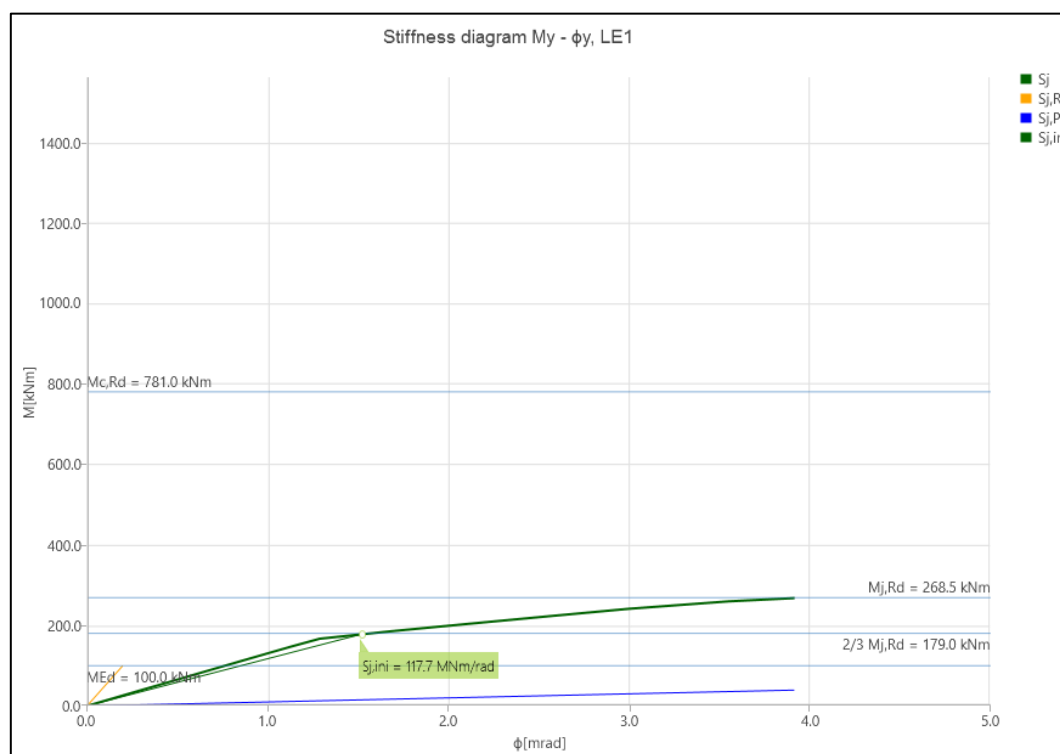
Figura 4.8 - Gráfico momento-rotação extraído do IdeaStatica para chapa de 20mm e parafusos M20
