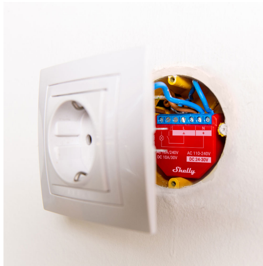
Figura 2.3: Relé Shelly implementado numa tomada [15].
