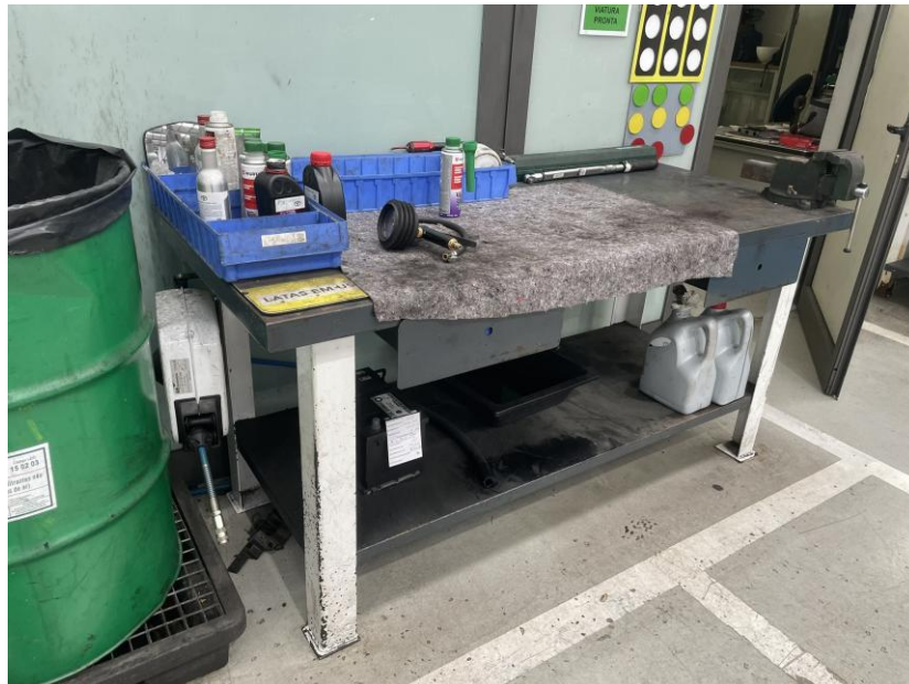
Figura 23 - Bancada de apoio ao bordo de linha.
