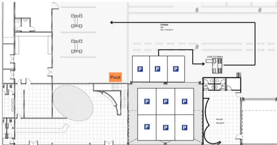
Figura 54 - Fluxo de uma viatura a realizar ITV e a ser alocada a uma baía.
