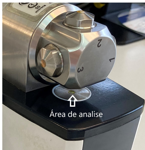
Figura 3.5.: Detalhe da área de análise do equipamento utilizado para análise FTIR.
