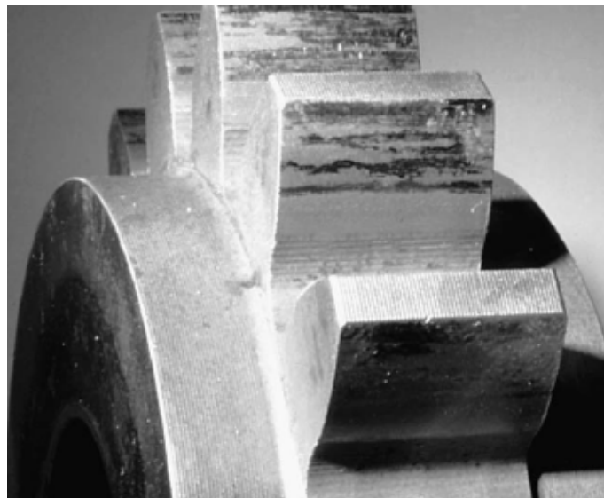
Figura 2.28.: Fenómeno de micropitting nos dentes de uma engrenagem [40].
