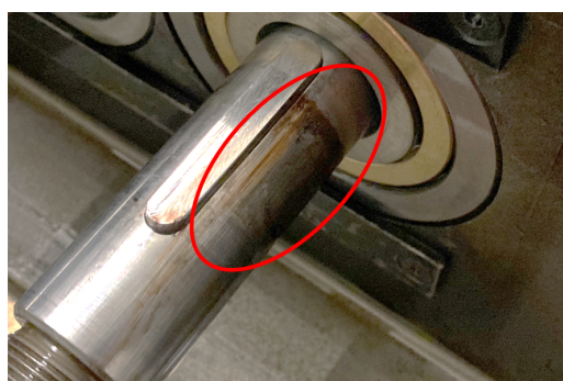
(a) Marcações no veio do pinhão causadas pelas vibrações do banco FZG.
