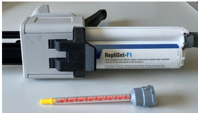
Figura 3.33.: Equipamento para aplicação do composto RepliSet-F1 para réplica da superfície.
