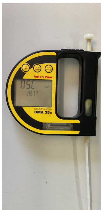
Figura 3.1.: Equipamento utilizado para efetuar a medição da densidade.
