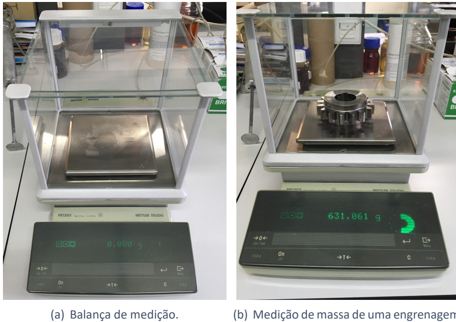
Figura 3.24.: Equipamento de medição de massa “METTLER TOLEDO PR 1203”. (a) Balança de medição; (b) Medição de massa de uma engrenagem.
