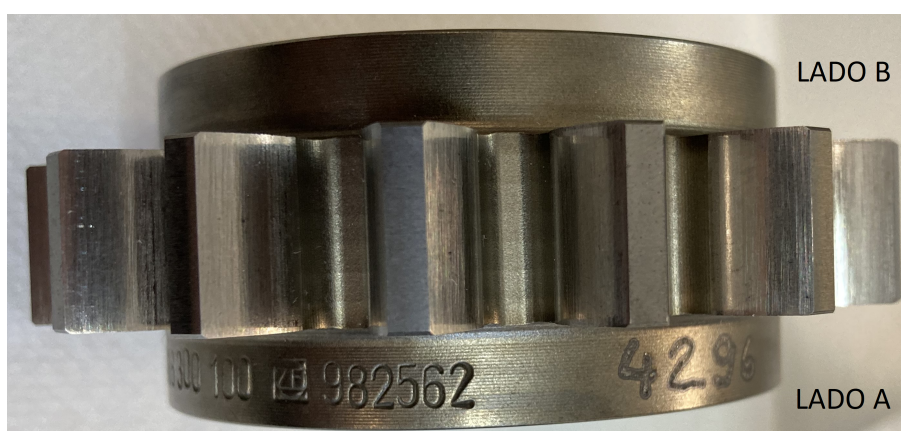
Figura 3.9.: Método de identificação dos diferentes lados/flancos da engrenagem
