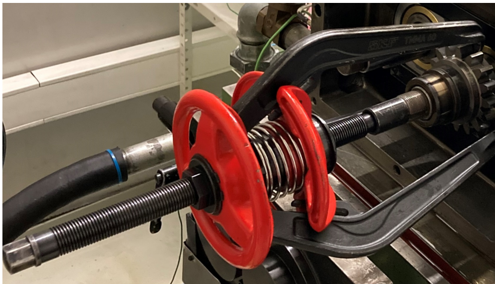
Figura 3.10.: Exemplo do procedimento de extração do pinhão.
