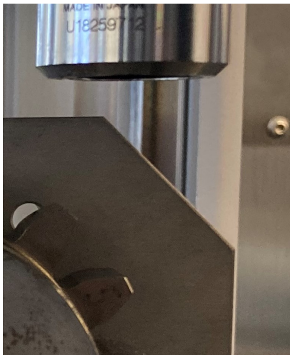
Figura 3.23.: Sobreposição dos dentes e espaço insuficiente para a medição da superfície no pé do dente.
