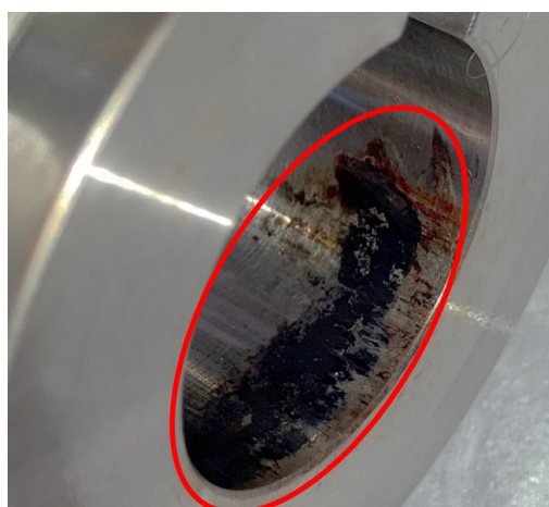
(b) Marcas no furo interior do pinhão causadas por vibrações.
