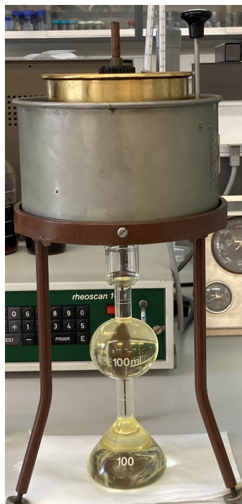
Figura 3.4.: Fase final da medição do tempo de escoamento utilizando um viscosímetro de Engler .
