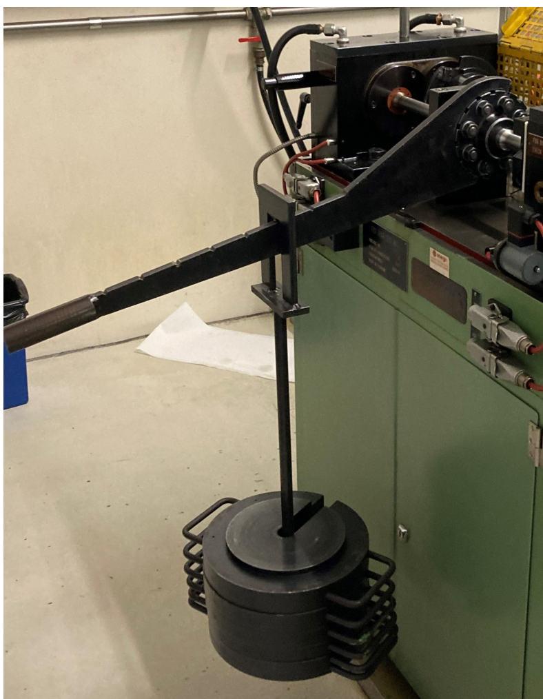
Figura 3.13.: Demonstração do carregamento da embraiagem para a realização do respectivo ensaio (estágio K9).
