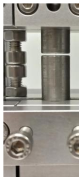
Figura 63- Alinhamento dos substratos e folga entre eles
