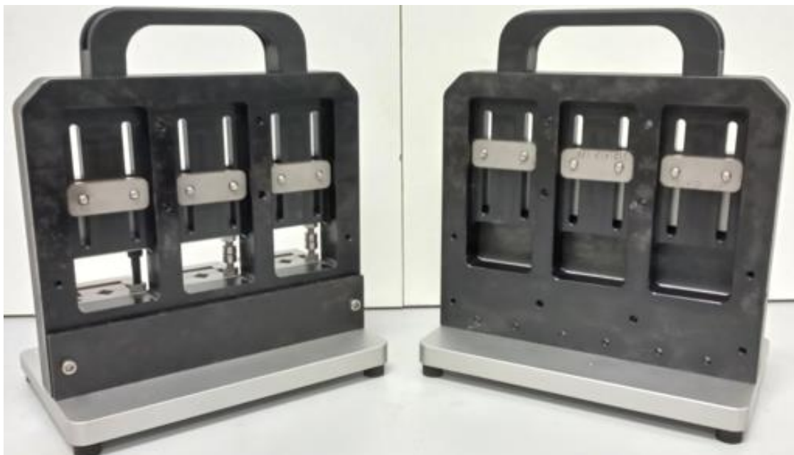
Figura 59- Imagens da ferramenta para fabrico de juntas topo a topo
