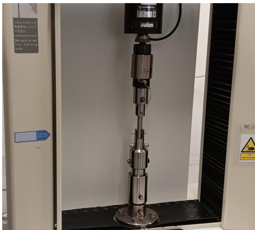
Figura 116- Máquina Shimadzu AGI 10 kN (LET)
