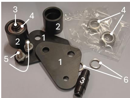
Figura 50- Ferramenta Rolete Flutuante parcialmente montada
