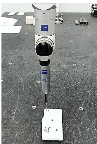
Figura 86 – Análise dimensional realizada por uma máquina CMM
