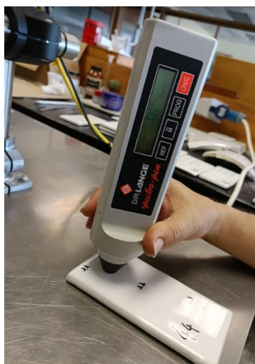
Figura 85 – Execução de uma leitura feita pelo colorímetro
