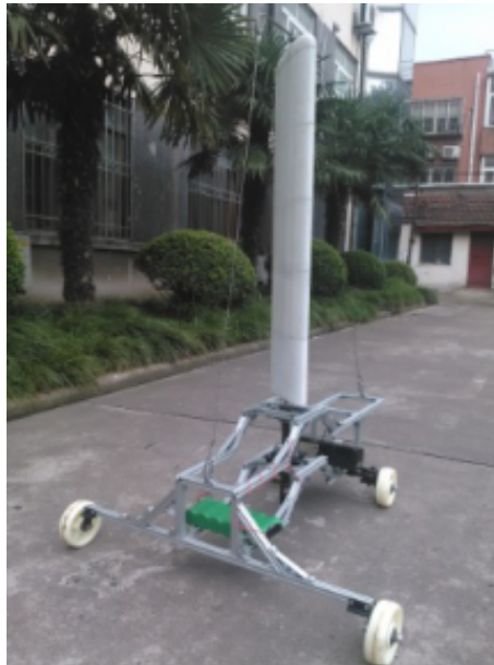
Figura 2.23: Protótipo do veículo autónomo de quatro rodas com propulsão por vela - Exemplo 1 [37]
