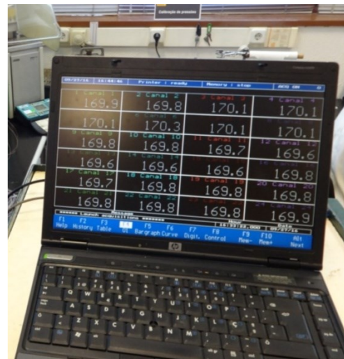
Figura 66: Equipamento para recolha de dados: a) dataLogger Agil II 80C535 . b) computador HP Compact nc6400 com o software Measure a correr.
