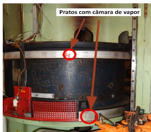
Figura 18: Pratos com câmara de vapor.
