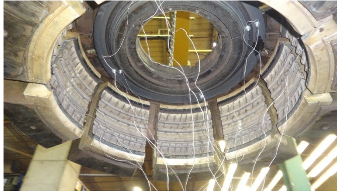
Figura 40: Termopares fixados nos segmentos, na parede superior e no anel do talão superior.
