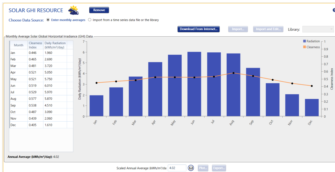
Figura 52 - Configuração do recurso solar, no Homer Pro
