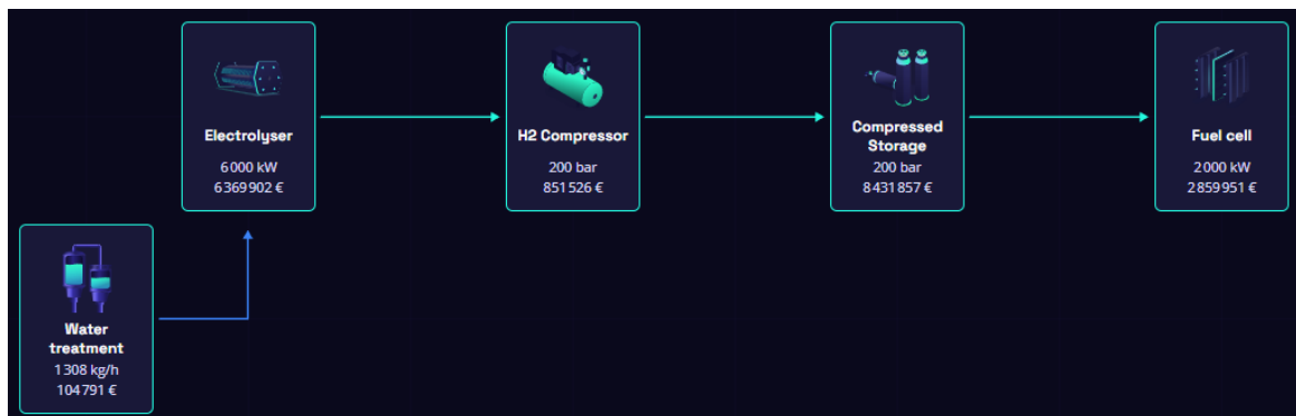
Figura 64 - Esquema simplificado da central de hidrogénio, obtido através do HyJack [111]
