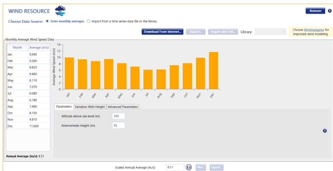
Figura 53 - Configuração do recurso eólico, no Homer Pro
