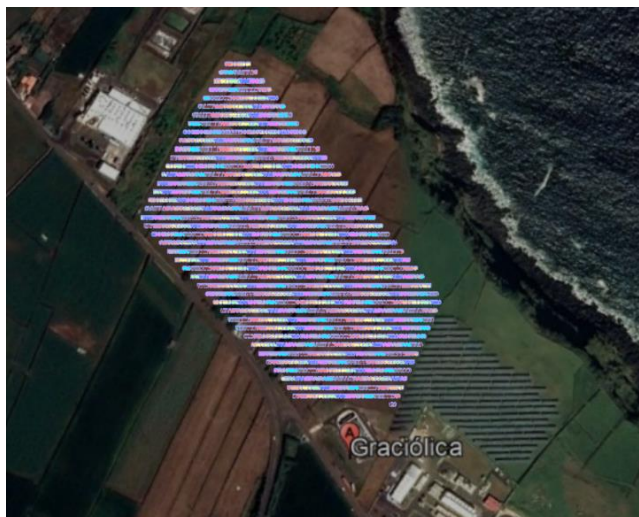
Figura 60 - Implantação PVSyst, 6,34 MWp
