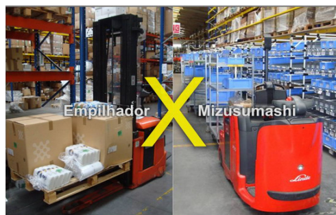
Figura 40 Comparação entre ambiente de funcionamento e aspeto físico do empilhador e do Mizusumashi (TaktTime.net, 2014)
