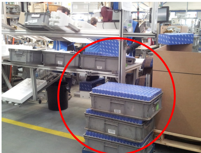
Figura 63 Exemplo de falta de espaço de acondicionamento em linha
